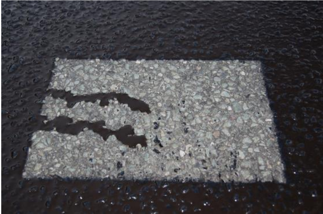
Figur 48 Strekning Q; Gammelt underlag med variert grov teksturdybde, MPD \approx 1,60; Bitumenemulsjon D (BE-D); Påført mengde restbindemiddel = 0,186 kg/m 2 .
