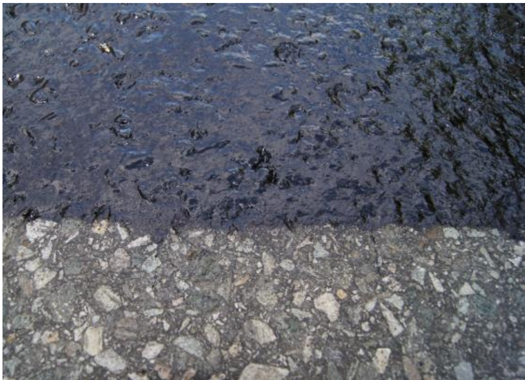
Figur 46 Strekning S; Gammelt underlag med glatt tekstur, MPD \approx 0,80; Bitumenemulsjon A (BE-A); Påført mengde restbindemiddel = 0,134 kg/ m 2 .
