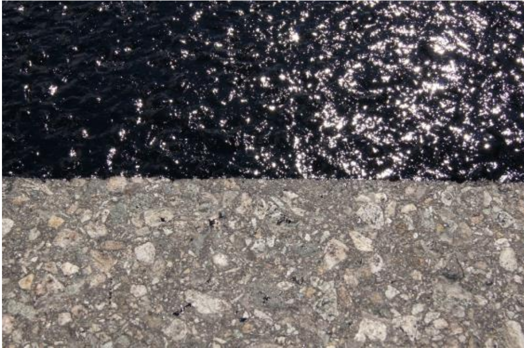
Figur 47 Strekning S; Gammelt underlag med glatt tekstur, MPD \approx 0,80; Bitumenemulsjon A (BE-A); Påført mengde restbindemiddel = 0,182 kg/ m 2 .
