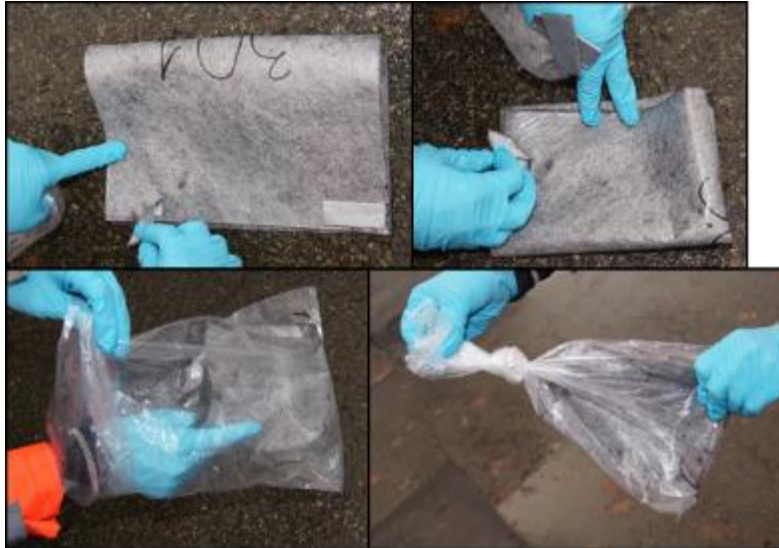
Figur 6 Bildene viser hvordan en prøveplate av fiberduk håndteres i felt når mengde emulsjon påført skal bestemmes ved veiing inne på laboratoriet.
