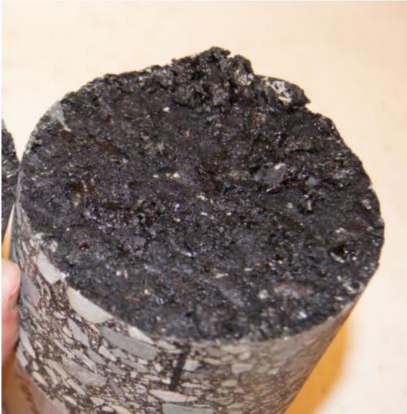
Figur 41 Bruddflate for en av kjernene tatt ut mellom hjulspor på strekning P, med laveste mengde klebemiddel.
