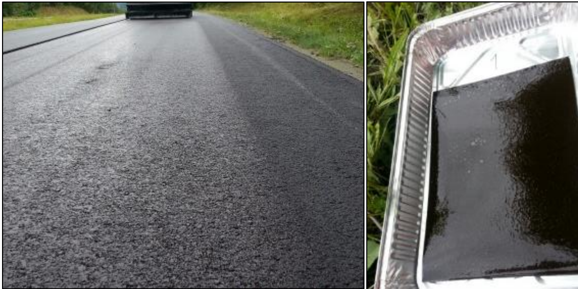
Figur 27 Bilder tatt under feltmåling av mengde klebemiddel påført på strekning A. Bildet til venstre viser underlaget rett etter limbilen har passert. Bildet til høyre viser hvor godt emulsjonen er fordelt på en hvit papp-plate.
