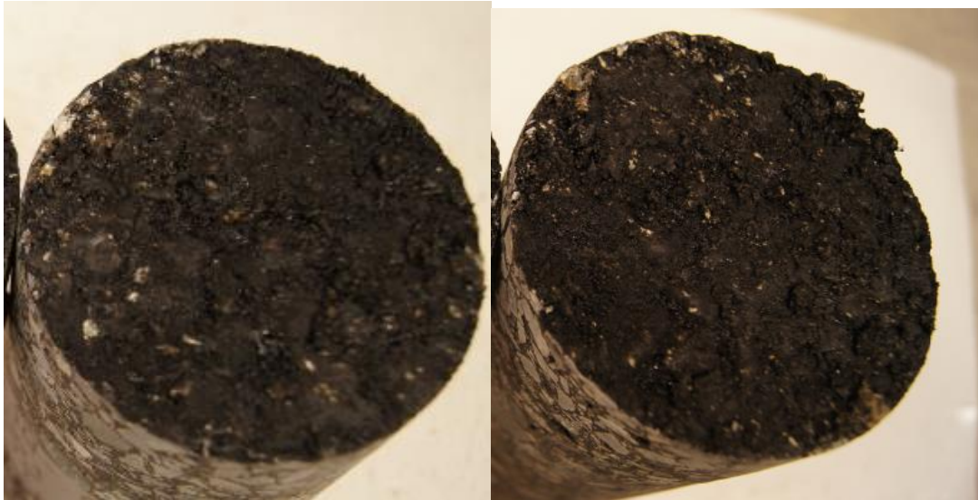
Figur 43 Bruddflate for en av kjernene tatt mellom hjulspor på strekning R, med laveste mengde klebemiddel ( 0,135 \text{ kg/ m}^2 ) til venstre og middels mengde klebemiddel ( 0,19 \text{ kg/ m}^2 ) til høyre.
