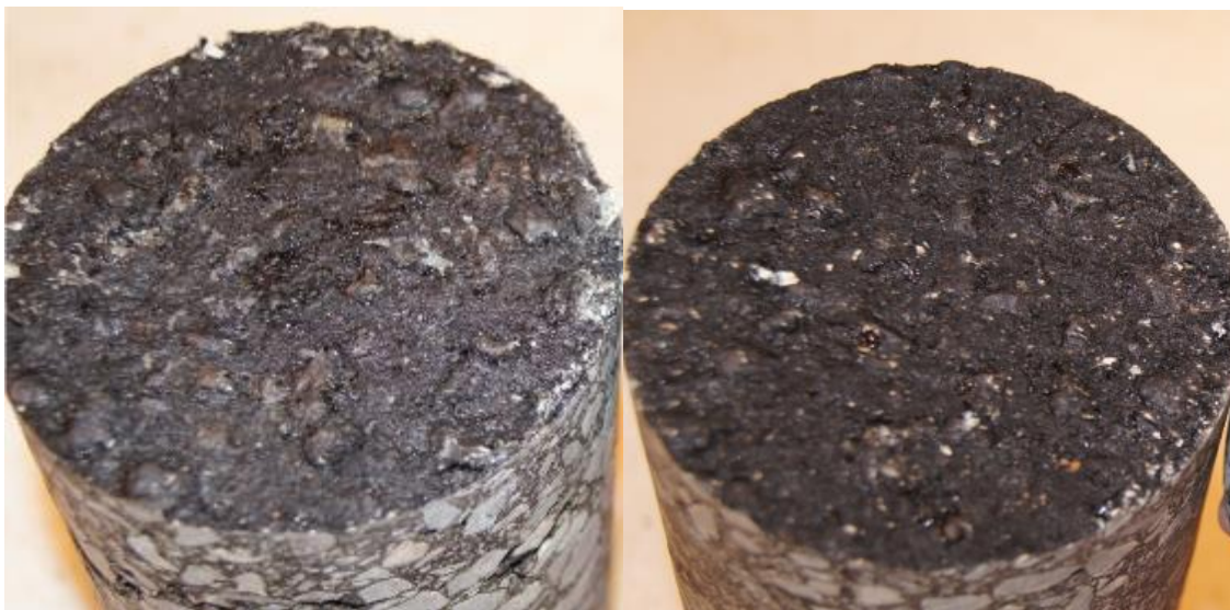
Figur 44 Bruddflate for to kjerner, tatt mellom hjulspor på strekning Q, med laveste mengde klebemiddel til venstre og høyeste mengde til høyre.
