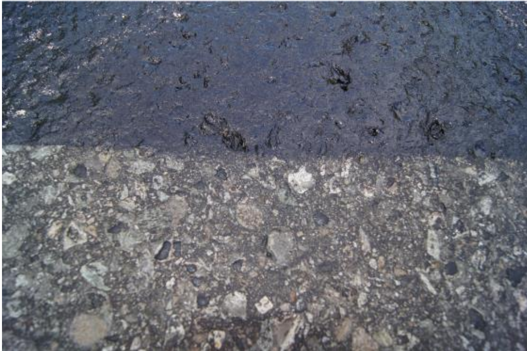
Figur 45 Strekning S; Gammelt underlag med glatt tekstur; MPD \approx 0,80; Bitumenemulsjon A (BE-A); Påført mengde restbindemiddel = 0,063 kg/m 2 .
