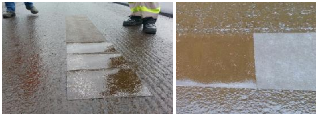
Figur 18 Bildene viser de to strekningene som gav henholdsvis 2 % (til venstre) og 5 % (til høyre) lavere resultat når mengde emulsjon ble målt kontra når mengde emulsjon ble beregnet fra målt bindemiddelandel og målt mengde bindemiddel (etter fordamping av vann).
