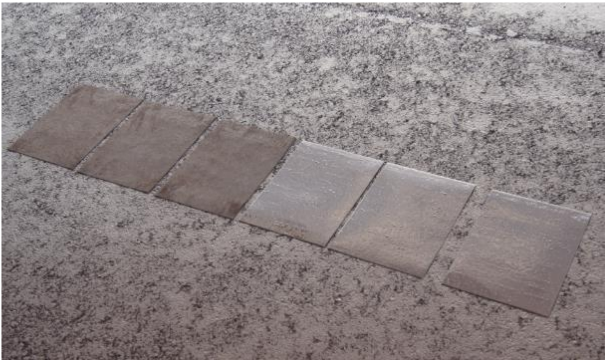
Figur 24 Bildet viser to typer prøveplater. Mengden er 0,28 l emulsjon/m 2 . Underlaget er nylagt asfalt.
