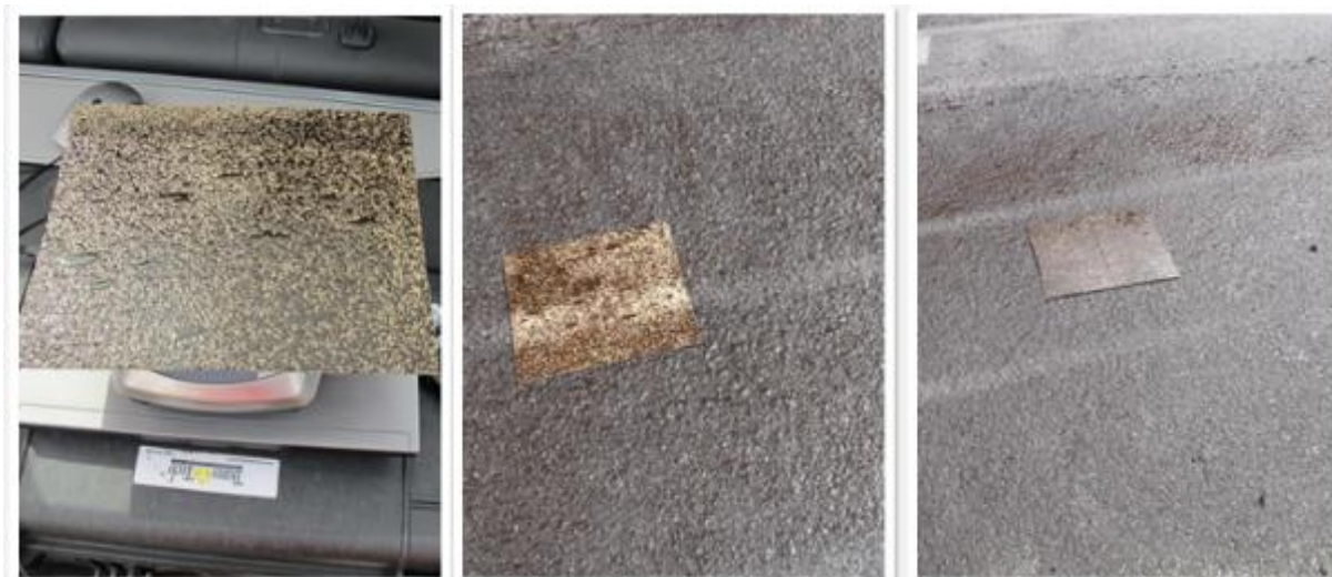
Figur 7 Mengde emulsjon målt med asfalteske som prøveplate.
