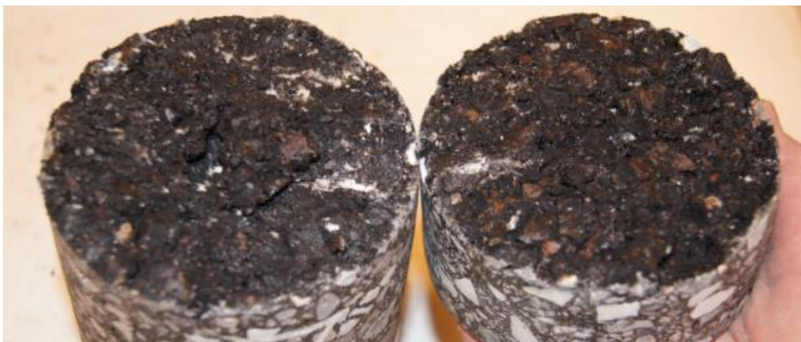
Figur 51 Bruddflatene for en av kjernene fra den freste strekningen U, uten påført klebemiddel.
