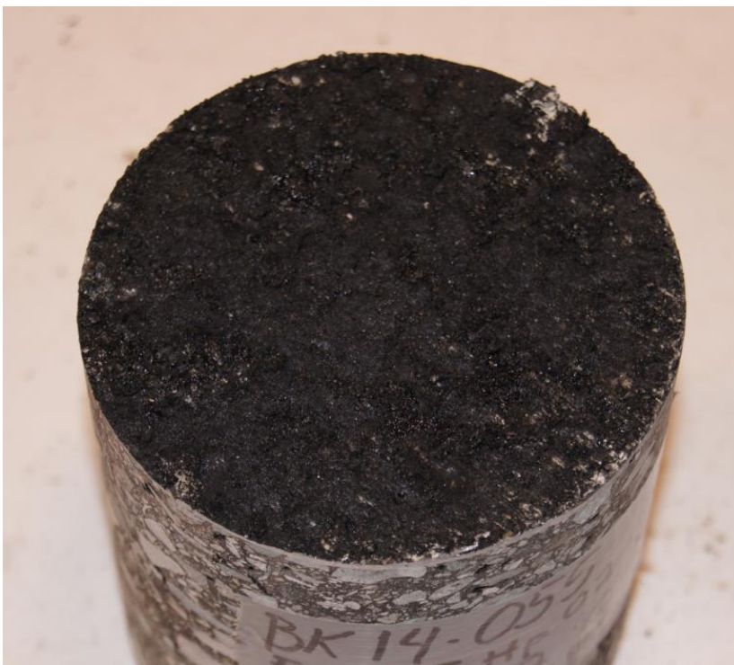
Figur 42 Bruddflaten for en av kjernene tatt mellom hjulspor på strekning S, med laveste mengde klebemiddel.
