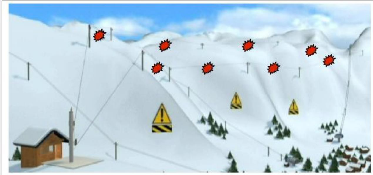
Figur 8: Prinsippskisse av et taubaneanlegg. Til venstre ses vinsjhuset. Tre skredløp er indikert med gule varselrekanter, med taubanetraseen ovenfor. Røde «stjerner» indikerer typiske utløsningspunkter for anlegget (illustrasjon hentet fra www.montaz.fr , 2015).
