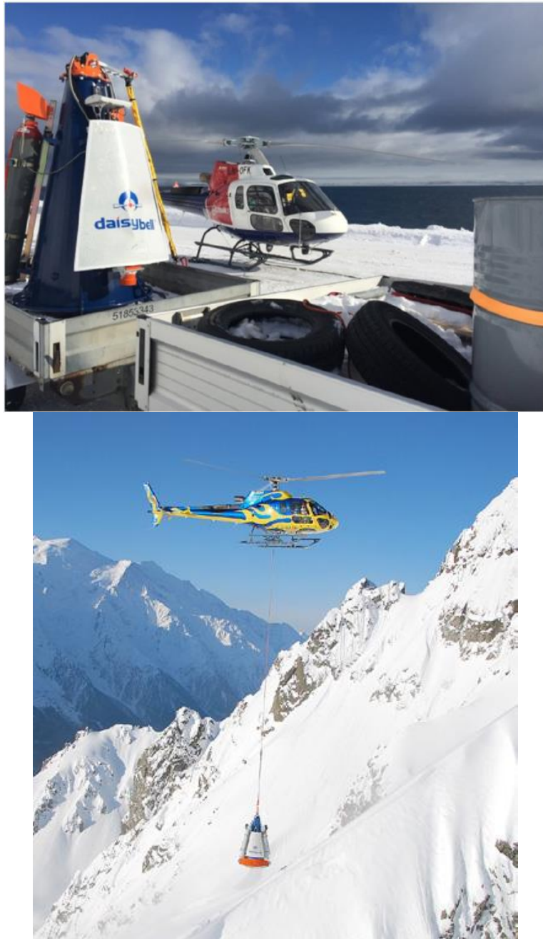
Figur 12: Øverst: Gassklokke klar for oppdrag (foto: Ole-André Helgaas, 2018). Nederst: Helikopter med underhengende gassklokke (DaisyBell) (Foto: T.A.S./Interfab).
