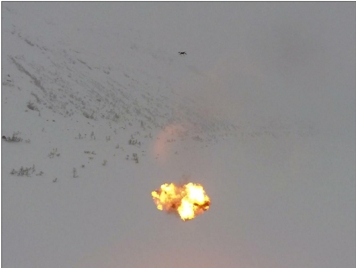
Figur 15: Detonasjon av 5,1 kg sprengstoff hengende i longline fra dronen under test på Fv. 13 Gaularfjellet i Sogn og Fjordane 27.3.2019 (Foto: AF Decom).
