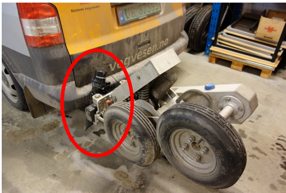
Figur 20 Teconer RCM411 montert på friksjonsmålebil
