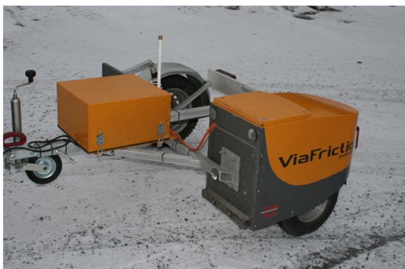
Figur 19 ViaFriction etterhengende friksjonsmåler.
