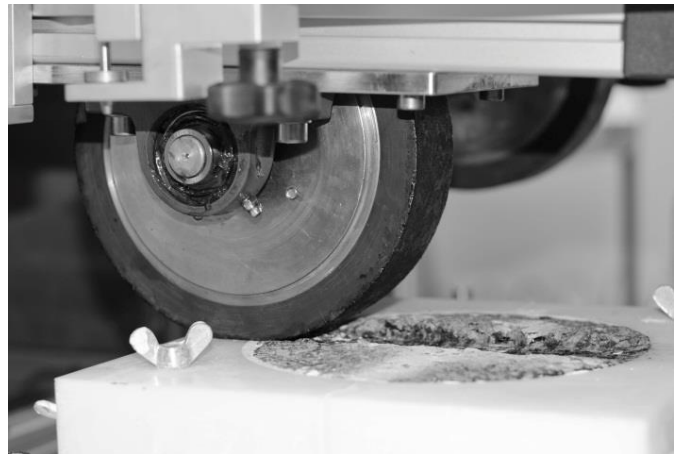
Figur 10.6 Wheel-track apparatur og prøve etter testing (Fotograf: Cooper (venstre) og SINTEF (høyre))
