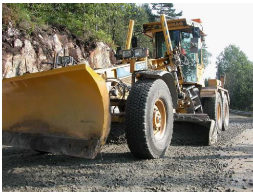
Figur 14.9 Høvling av grusveg. (Foto: Statens vegvesen)
