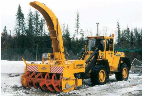
Figur 21.6 Hjullastermontert trommelfres (venstre, Foto: Øveraasen). Bildet til høyre viser en snøfres som fjerner brøytekant og kaster snøen tvers over vegbanen (Foto: Statens vegvesen)
