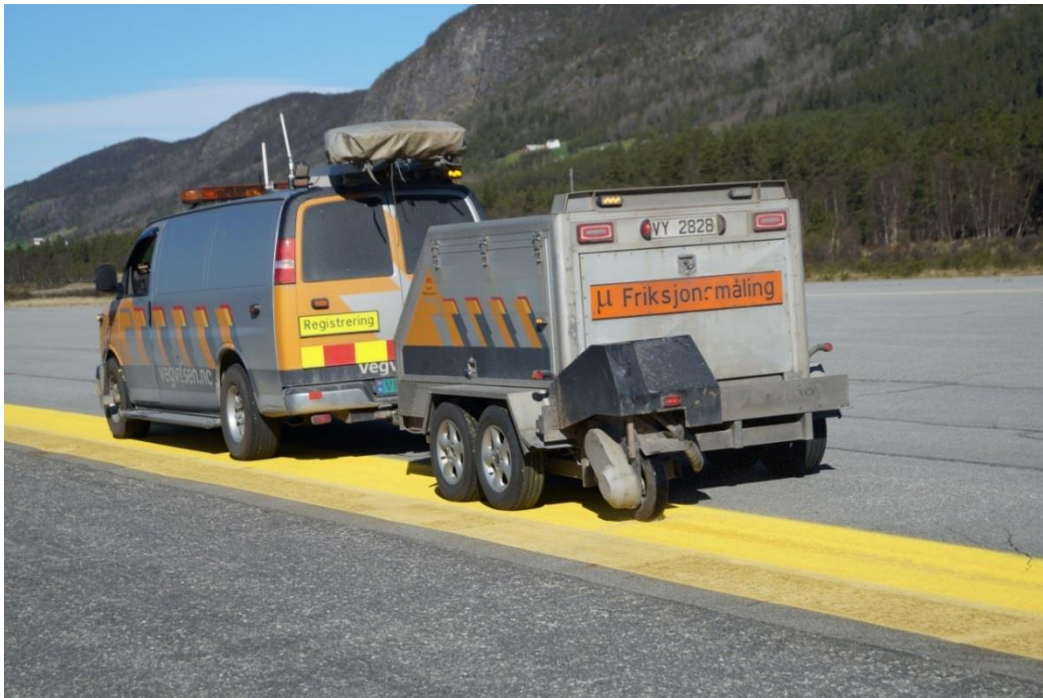
Figur 11.11 Friksjonsmåling med ROAR5 (Foto: Bård Nonstad)
