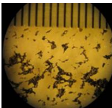
Figur 12.13 Mikroskopbilde av slitasjepartikler fra bremsende bildekk. Foto: Alex K. Paste, NTNU
