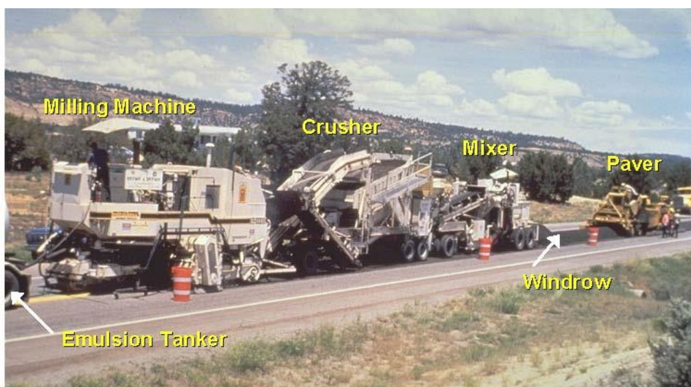
Figur 14.33 Eksempel på maskinkombinasjon ved kald gjenvinning på veg. (Foto: PIARC) /11/
