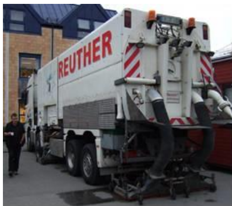
Figur 14.28 Vannjet (høytrykkspyler) for friksjonsforbedring. Ubehandlet og behandlet dekke. (Foto: Vegard Opsahl)
