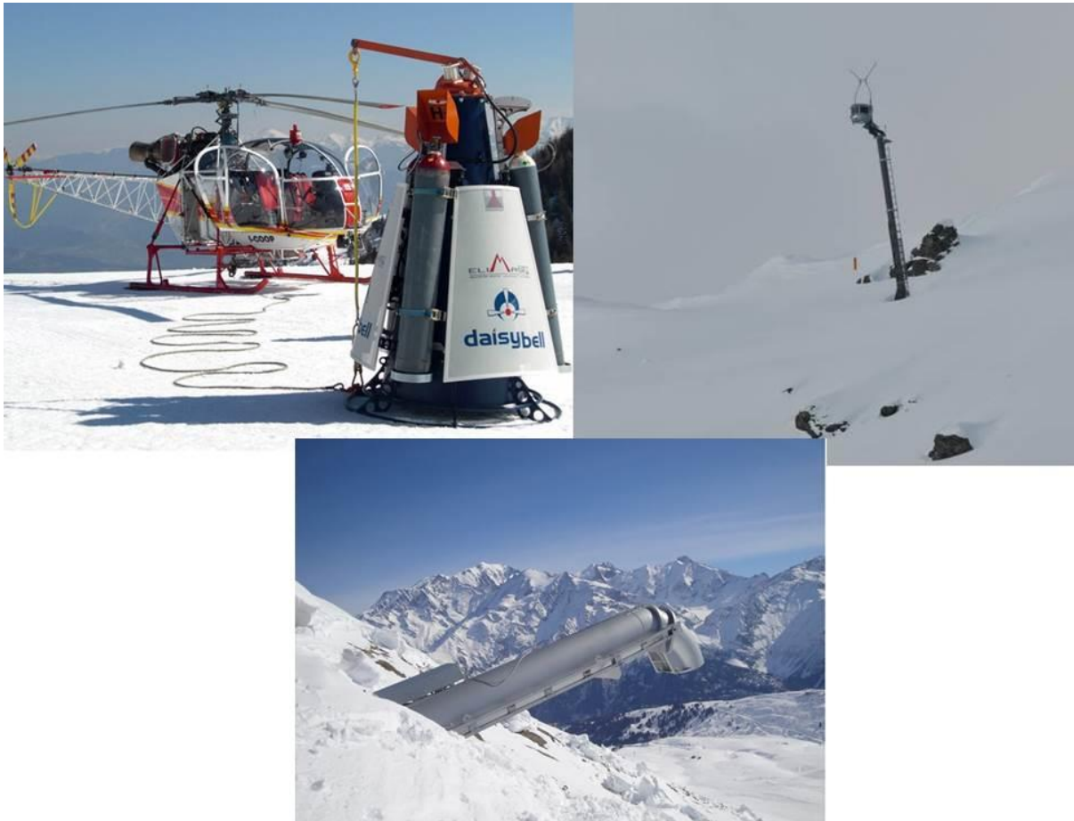
Figur 22.10. Ulike metoder innen aktiv skredsikring. Oppe til venstre Daisybell som er en mobil gasshylse (Foto: TAS). Oppe til høyre Wyssen sprengdtårn (Foto: Wyssen). Nederst Gazex gassrør (Foto: TAS)
