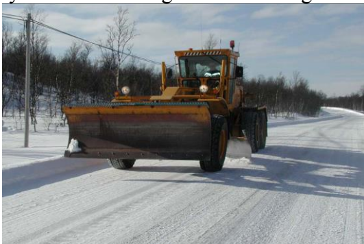
Figur 21.7 Veghøvel med underskjær i aksjon, til høyre jevnt snø-/isdekke etter høvling (Foto: Statens vegvesen)
