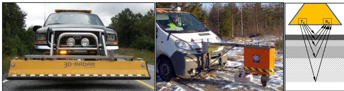
Figur 11.9 Georadar – GPR. Ulike georadarantenner. (Foto, tv: SINTEF)
