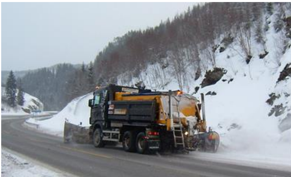
Figur 21.14 Brøyting og salting av vinterveg. (Fote: Kai Rune Lysbakken)
