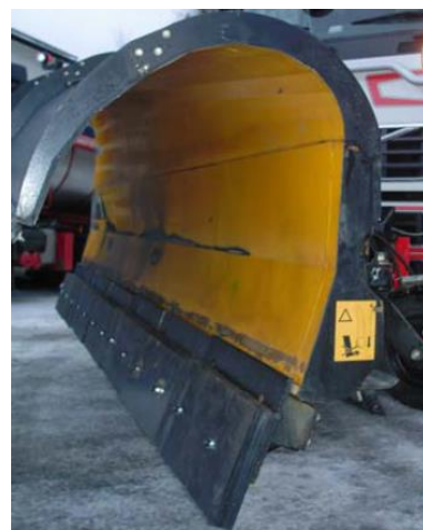
Figur 21.5 Underskjær montert på brøytebil (venstre) og Trelleplow gummiskjær (høyre) (Foto: Statens vegvesen)
