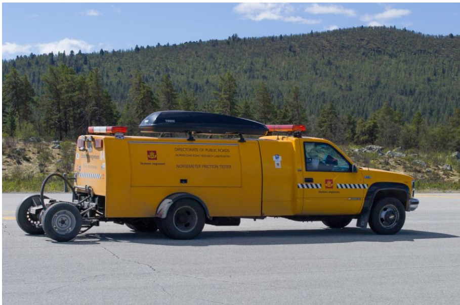
Figur 12.33 Friksjonsmåleren OSCAR er referansemåleren for friksjon i Norge. Foto: Erik Espe, ViaTech AS
