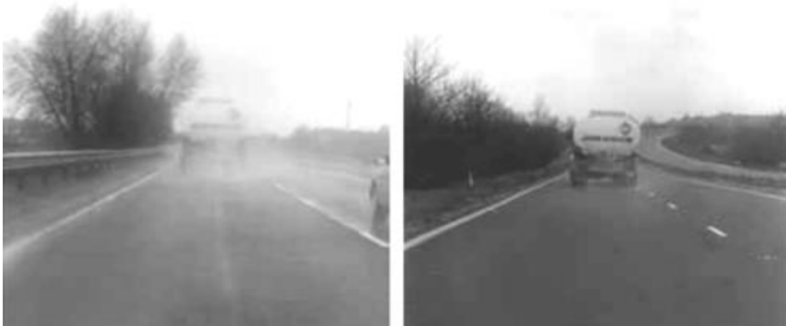
Figur 8.3 Våt vegbane kan gi svært dårlige siktforhold (TRB 09-1913, Rungruangvirojn and Kanitpong)
