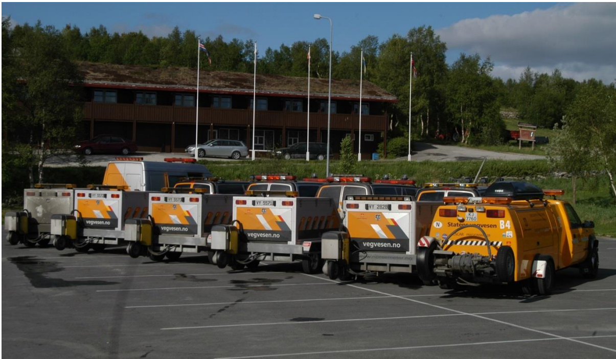
Figur 12.36 Kalibrering av referansemålere (OSCAR til høyre og fem stk. Roar Mark5). Foto: Knut Opeide, Statens vegvesen
