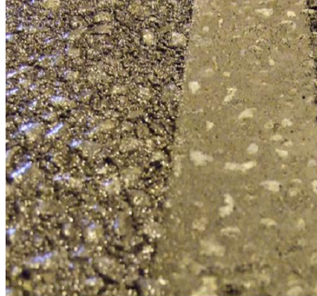
Figur 12.38 Høytrykkspyling av vegdekker. Behandlet asfalt til venstre, ubehandlet til høyre Foto: Vegard Opsahl, Statens vegvesen
