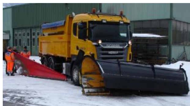
Figur 21.4 Brøyting med spissplog på høyfjellet (venstre, foto Geir Brekke) og brøytebil med diagonalplog og sideplog (høyre, foto Statens vegvesen)
