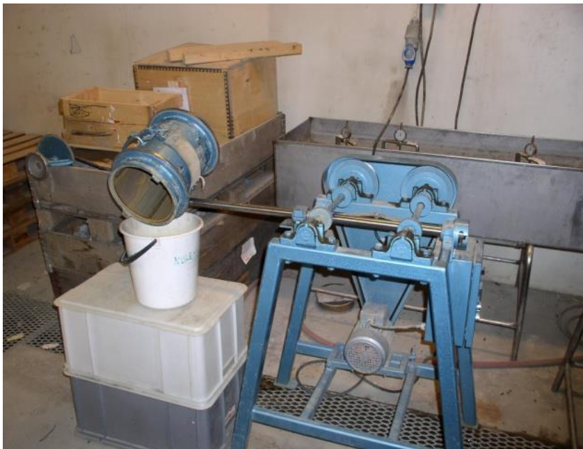
Figur 10.3 Kulemølle (Foto: SINTEF)
