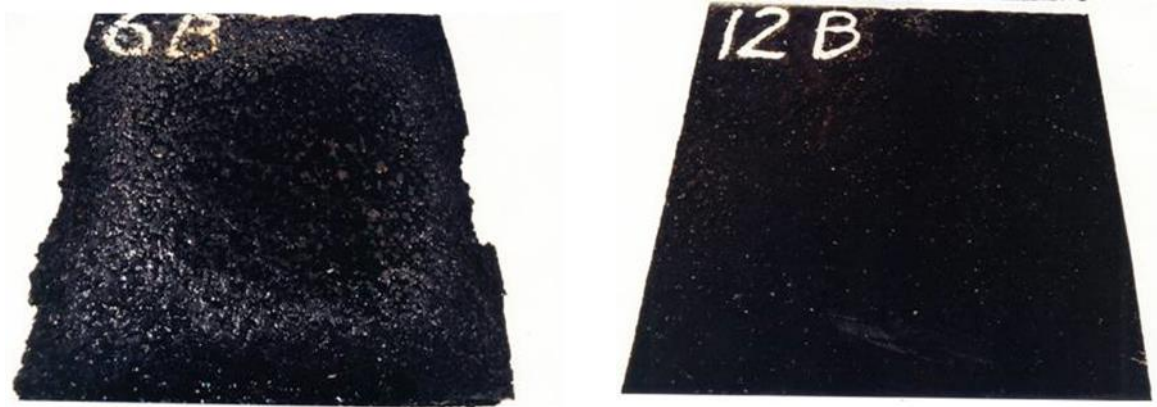
Figur 10.9 Prøver av Ab 11 (asfaltbetong) etter et halvt års simulert aldring i laboratorium, til venstre med ordinær bitumen 160/220, til høyre med bitumen 160/220 tilsatt 6 vekt-% polymer (Foto: Joralf Aurstad)
