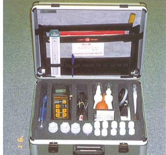
Figur 19.8 Utboring av betongstøv fra konstruksjonen og utstyr for kjemisk analyse av kloridinnhold (Foto: Eva Rodum og Håndbok V441)
