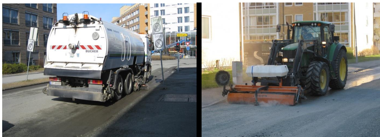
Figur 24.1 Feiebil og traktor som brukes i bygater og tettsteder (Foto: Øystein Larsen)
