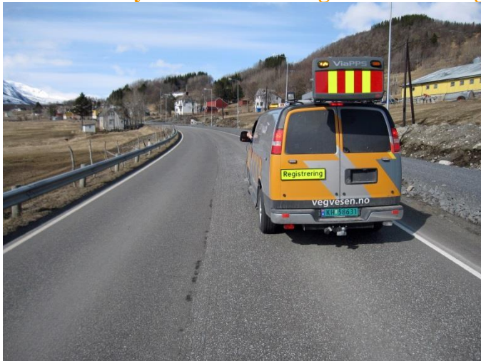
Figur 9.7 Tilstandsmålinger av spor og jevnhet utføres med ViaPPS (Foto Torleif Haugødegård)
