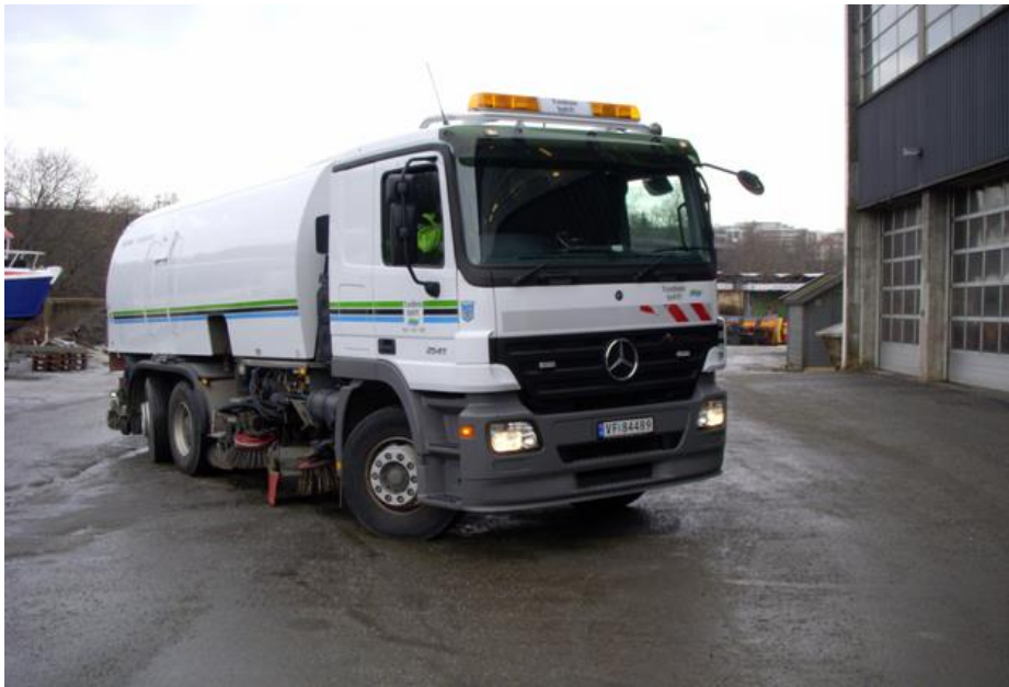
Figur 23.3 Stor feievogn som brukes til feiing av gater og veger i Trondheim, Foto: Terje Lindland
