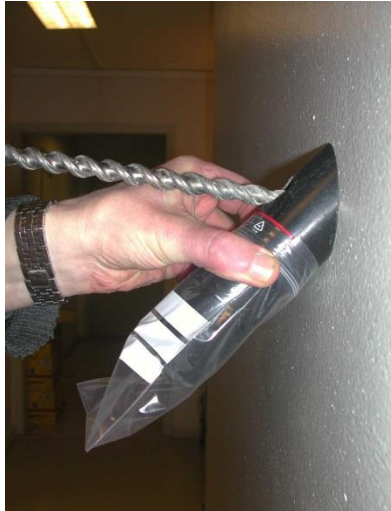
Figur 19.8 Utboring av betongstøv fra konstruksjonen og utstyr for kjemisk analyse av kloridinnhold (Foto: Eva Rodum og Håndbok V441)
