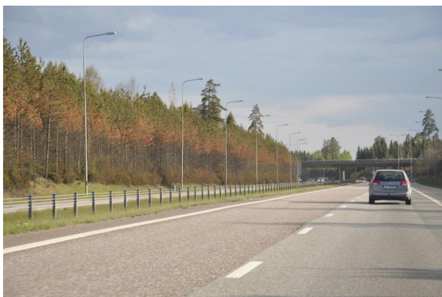
Figur 21.17 Saltskader på vegetasjon nær vegbanen kan sees flere steder
