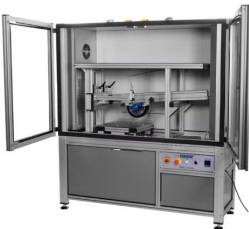
Figur 10.6 Wheel-track apparatur og prøve etter testing (Fotograf: Cooper (venstre) og SINTEF (høyre))
