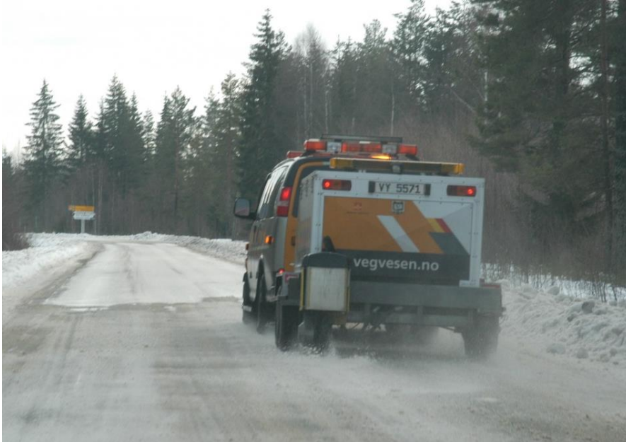
Figur 2.3 Friksjonsmåling på vinterveg. (Foto: Håkon Aurlien, Statens vegvesen)
