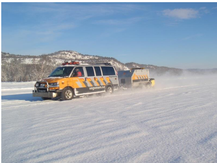
Figur 12.34 Friksjonsmåling på vinterføre med Roar Mark 5. Foto: Bård Nonstad, Statens vegvesen
