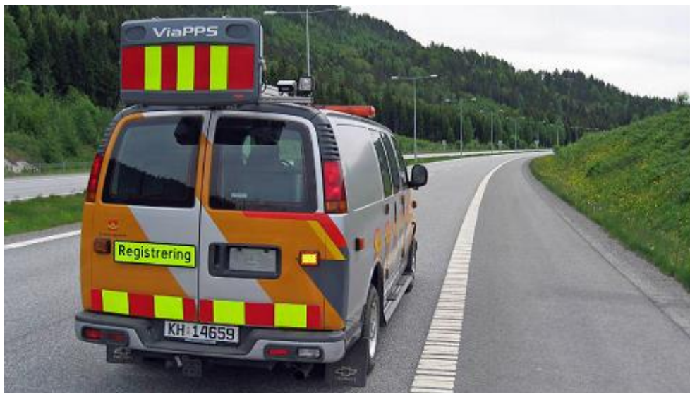
Figur 11.1 Målebil for spor-, tverrfall- og jevnhetsmåling (Foto: Torleif Haugødegård)
