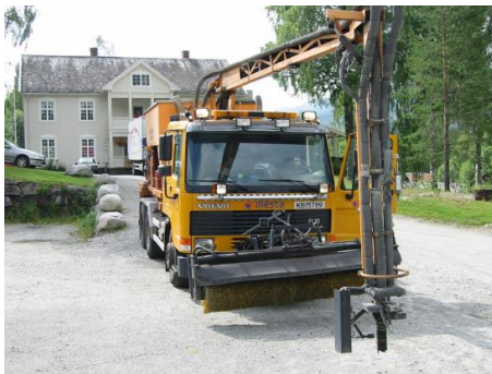
Figur 14.24 Lappekanon for reparasjon av hull (Mesta). (Foto: Noralf Haugvaldstad)
