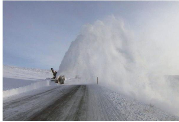
Figur 21.6 Hjullastermontert trommelfres (venstre, Foto: Øveraasen). Bildet til høyre viser en snøfres som fjerner brøytekant og kaster snøen tvers over vegbanen (Foto: Statens vegvesen)
