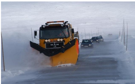
Figur 21.4 Brøyting med spissplog på høyfjellet (venstre, foto Geir Brekke) og brøytebil med diagonalplog og sideplog (høyre, foto Statens vegvesen)
