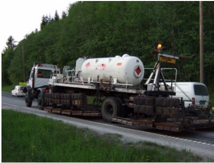
Figur 14.21 Forvarming før asfaltering. (Foto: Vegard Opsahl)
