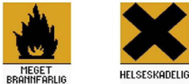
Figur 4.10 Kjemikalier skal merkes på denne måten fram til 1. juni 2015. Fra det tidspunkt tas nye merkesymboler i bruk i henhold til EUs CLP-forordning nr. 1272/2008 om klassifisering, merking og emballering av stoffer og stoffblandinger.
