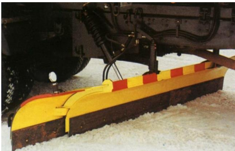
Figur 21.5 Underskjær montert på brøytebil (venstre) og Trelleplow gummiskjær (høyre) (Foto: Statens vegvesen)
