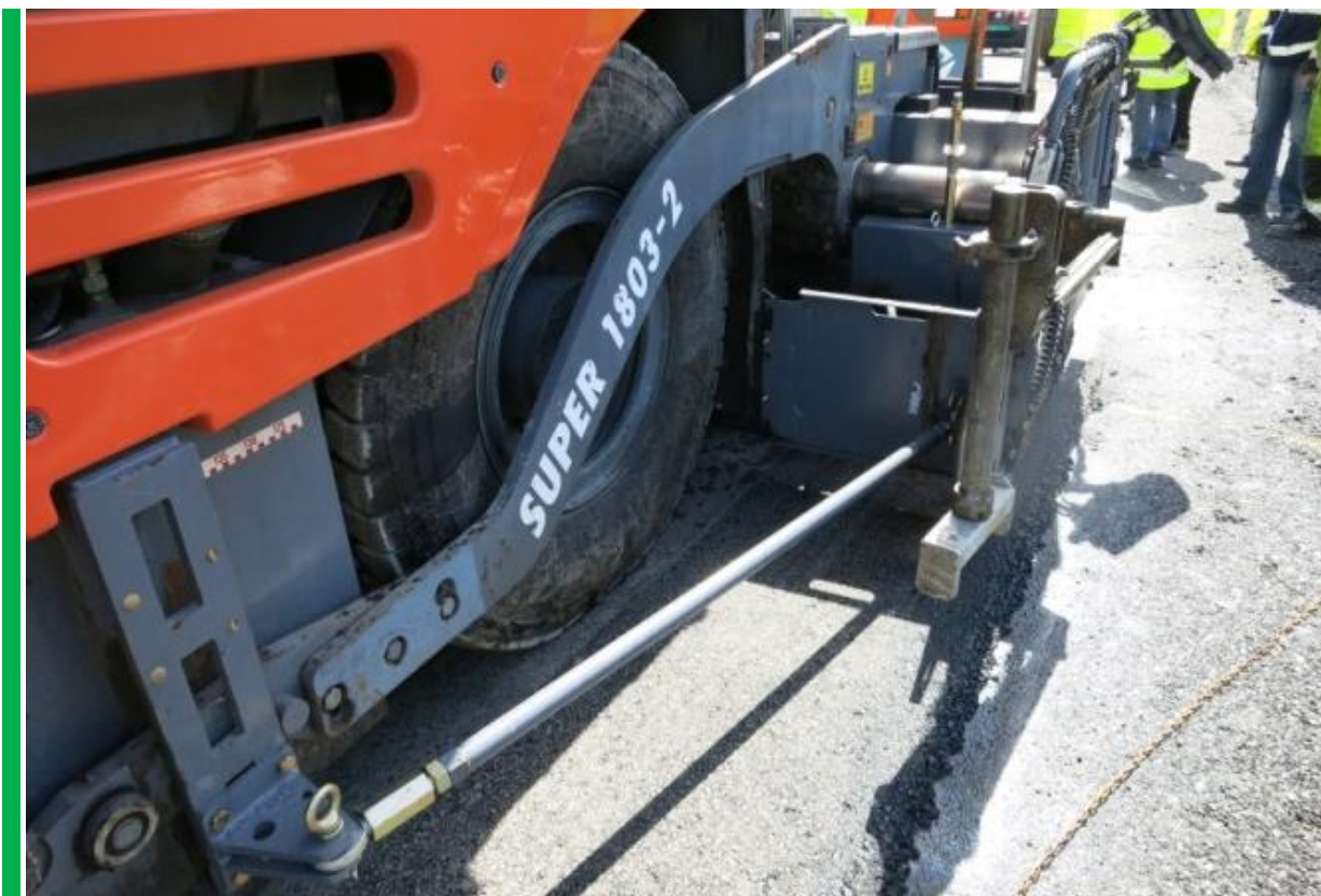
Riktig: Ved fast bredde, må skrueforlengere og tunnelplate monteres (foto: Roar Telle)
