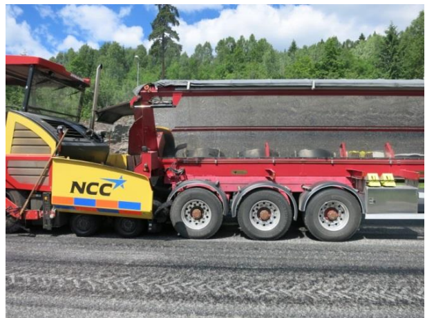
Eksempel: Spesialbil "Redriver" med båndmating til utlegger (foto: Roar Telle)
