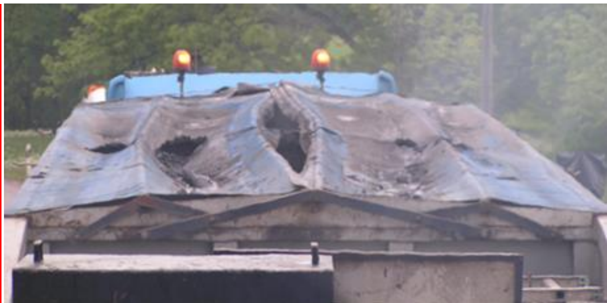
Feil: For å unngå avkjøling skal tildekkingen av baljen være hel og uten glipper (foto: Conny Andersson)
