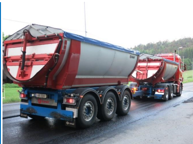
Eksempel: Vanlig utstyr for transport av asfalt: Isolert asfaltbalje (foto: Roar Telle)
