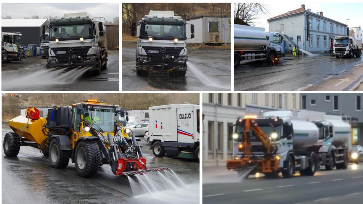
Figur 4: Spyling med maskin og for hånd (foto: Brynhild Snilsberg, Kai Rune Lysbakken og Adressa)
