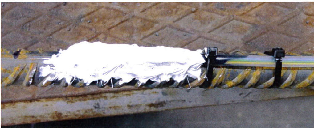
Figur 4 - Strekkklapp beskyttet med polyuretangummi
