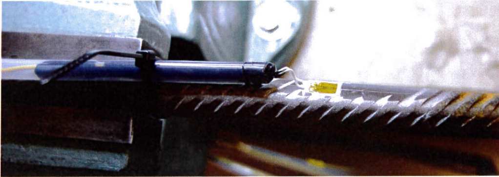
Figur 2- Strekkklapp limt på kamstål
