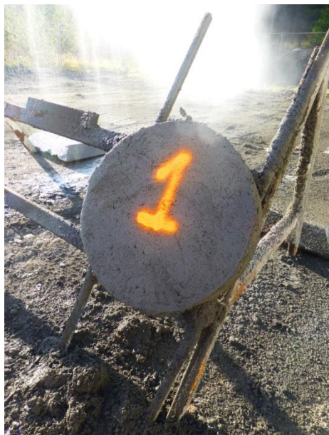
Figur 17 Nysprøytet prøveplate. Foto: Synnøve A. myren, Statens vegvesen
