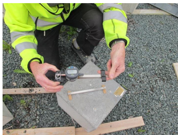
Figur 6 Måling av ekspansjon på felteksponerte kuber. Foto: Eva Rodum, Statens vegvesen
