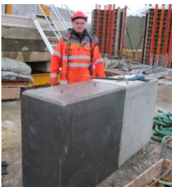
Martin Gedra ved det store prøveelementet etter avforming og påføring av hydrofoberende impregnering (halve elementet)
