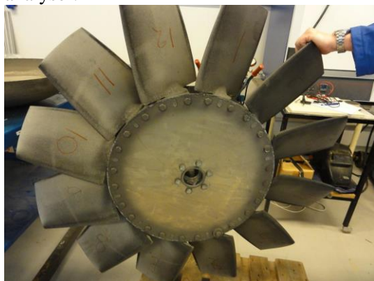
Figur 11 Tunnelventilatorrotor til undersøkelse hos Teknologisk Institutt
