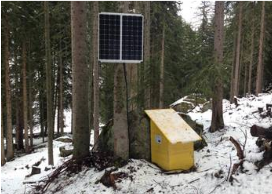
Figur 5. Sentral enhet med datalogger, dataoverføring og strømforsyning( www.wyssen.com )
