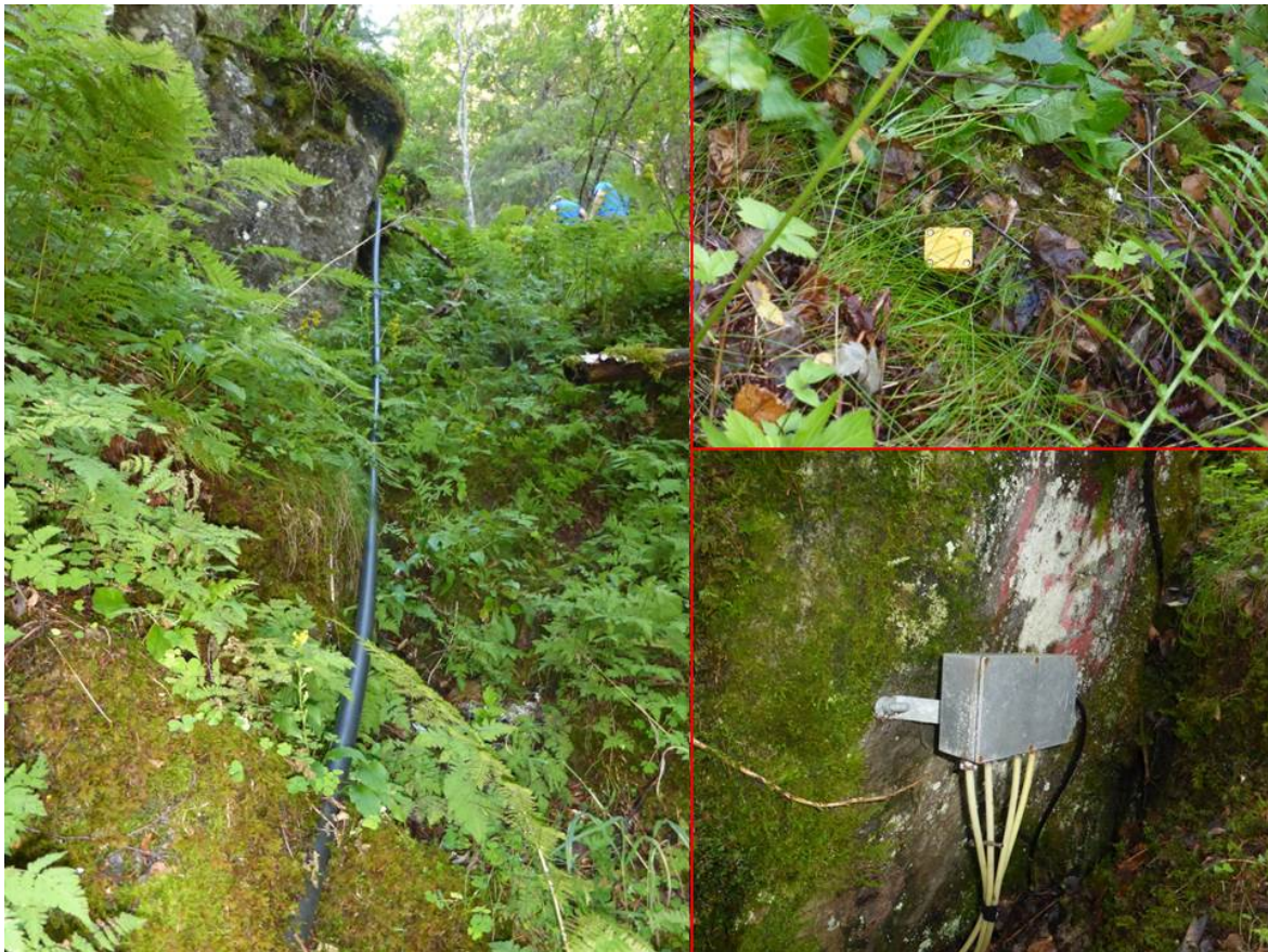
Figur 2. De to bildene til høyre viser en geofonene montert i skredløpet(øverst), og den øvre styringsboksen(nederst). Den øvre styringsboksen kobler sammen de 4 ledningene fra geofonene til en kabel. Bilde til venstre viser PVC røret som beskytter kabelen. Røret ligger åpnet i terrenget ca. de øverste 400 meterne(Foto: Heidi Bjordal).
