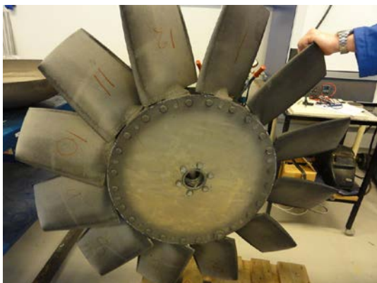
Figur 17 Tunnelventilatorrotor til undersøkelse hos Teknologisk Institutt
