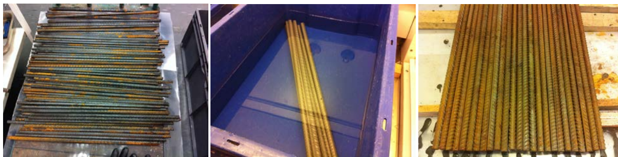
Figur 28 Korrosjonsforsøk, fase 2 – kjemisk rensing og pre-korrosjon av armering før innstøping. Foto: Claus K. Larsen, Statens vegvesen
