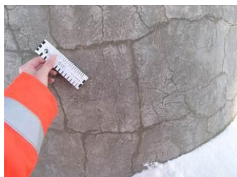
Måling av rissvidder, foto: Eva Rodum (SVV)
