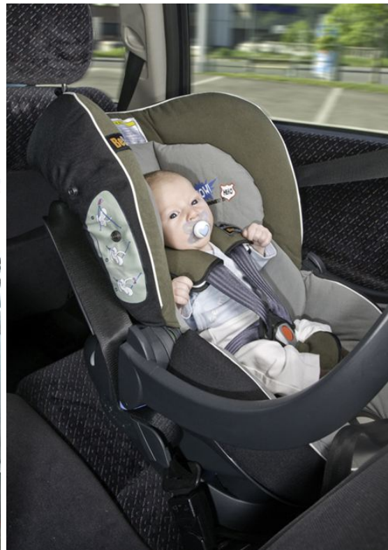
Foto 4 – Bakovervendt barnestol 0- 1 år. Det er viktig at skulderstropper holdes samlet for å unngå at barnet blir ut av setet ved en bråstopp.
