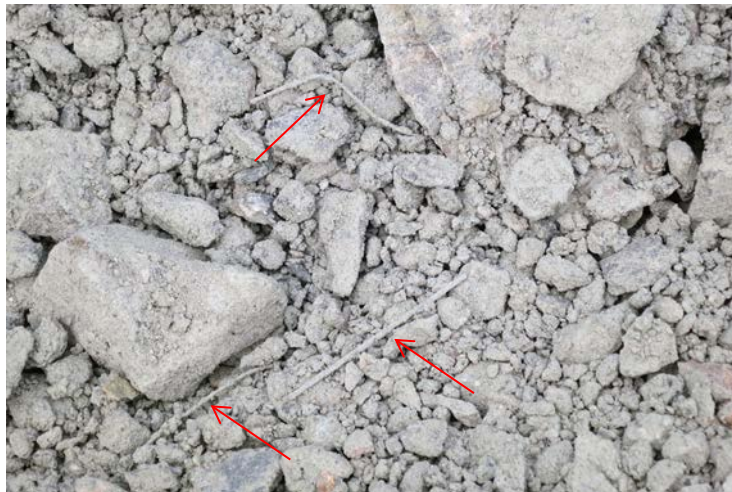
Figur 1: Sprengsteinsmasser med sementdekte makro pp-fiber fra sprøytebetong. Fibrene er markert med røde piler for å synes bedre på bildet. (Foto: Hedda Vikan 2012)
