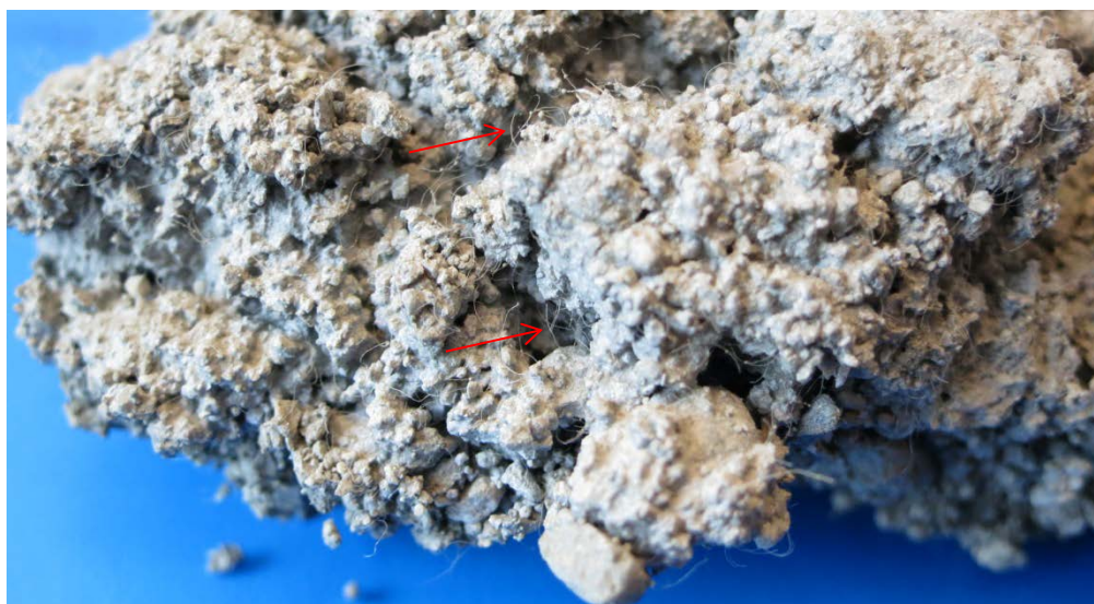
Figur 9: Prøve av prelltap med brannsikringsfibre. To røde piler er lagt inn i bildet for å tydeliggjøre fibrene. (Foto: Hedda Vikan 2013)
