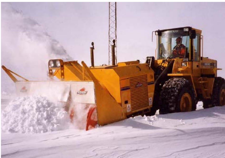
Figur 7-27 To-trinnsfreser med egen driftsmotor tilkoblet hjullaster
