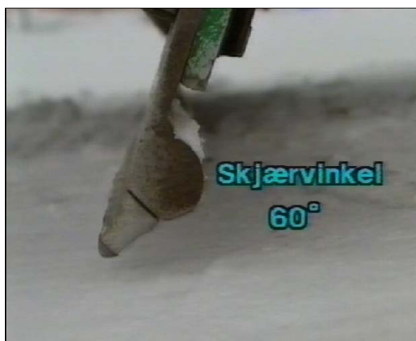
Figur 7-35 Riktig skjærvinkel med System 2000
