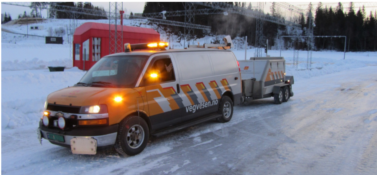
Figur 5-9 Friksjonsmåling på vinterføre med RoAR5
