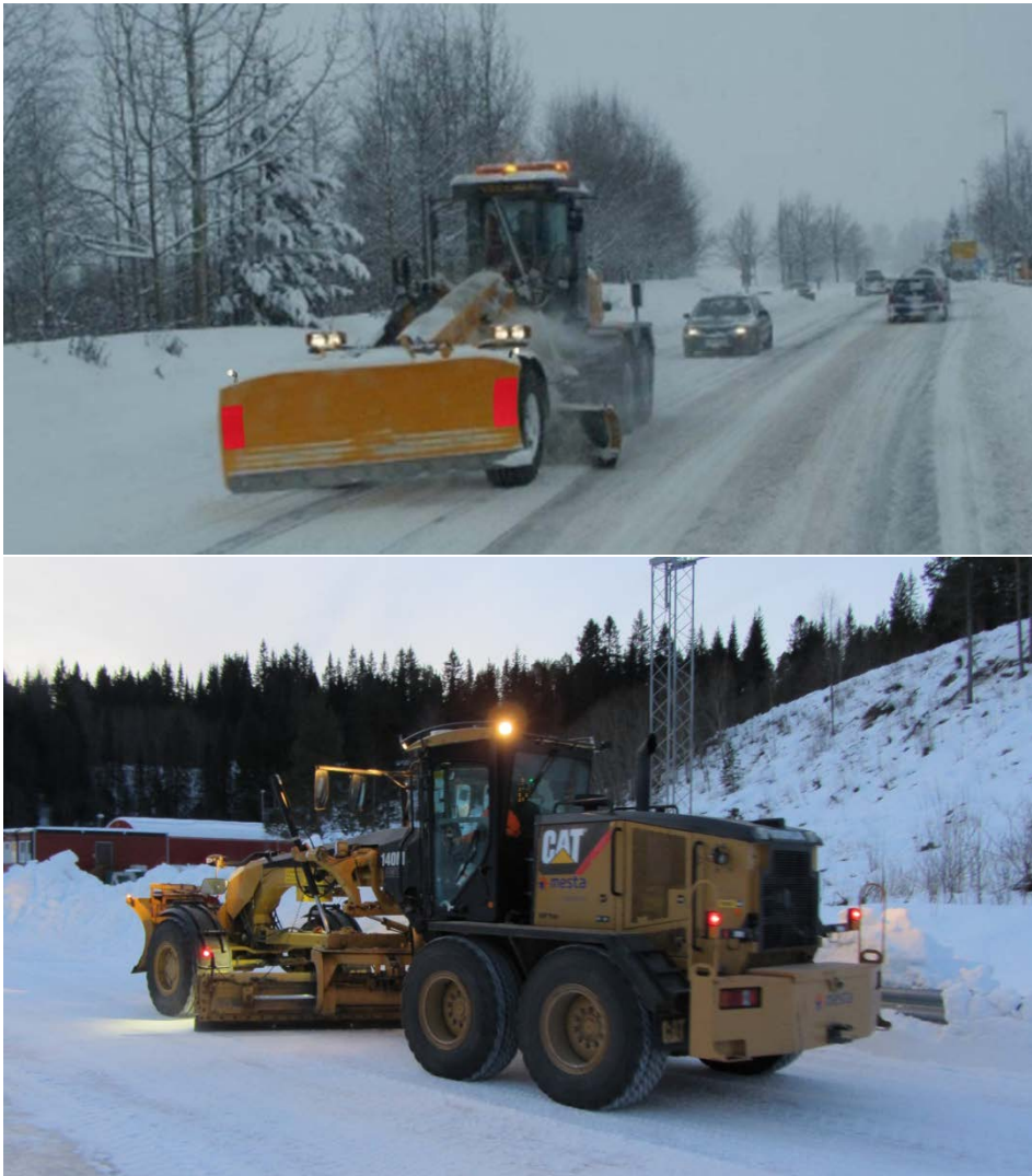
Figur 4-11 Veghøvel med isriverskjær og frontblad
