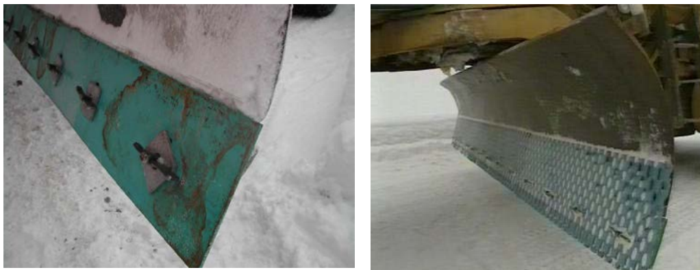
Figur 7-30 a) Slett sliteskjær - b) P300 (perforert skjær)
