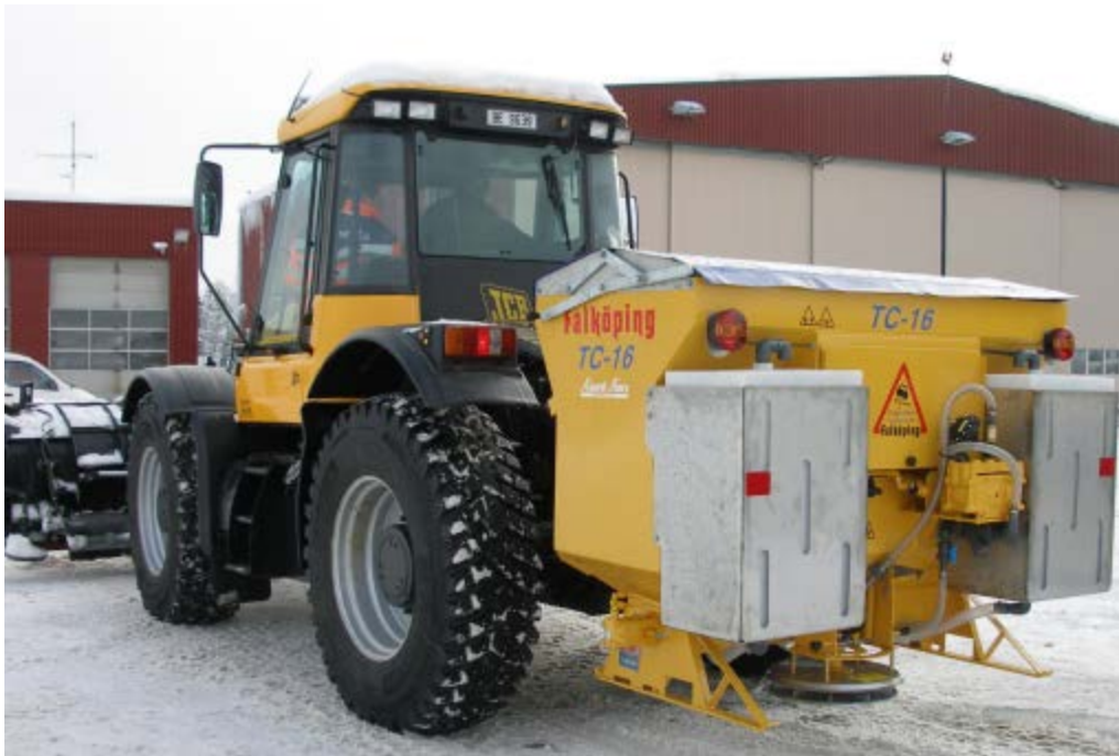
Figur 5-20 Bakmontert strøpparat for traktor
