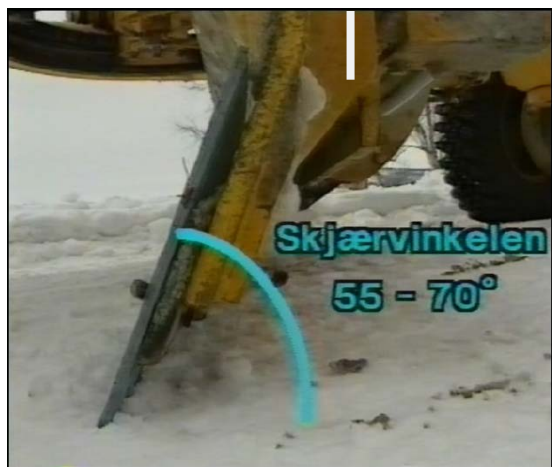
Figur 7-34 Riktig skjærvinkel mellom høvelskjær og underlag
