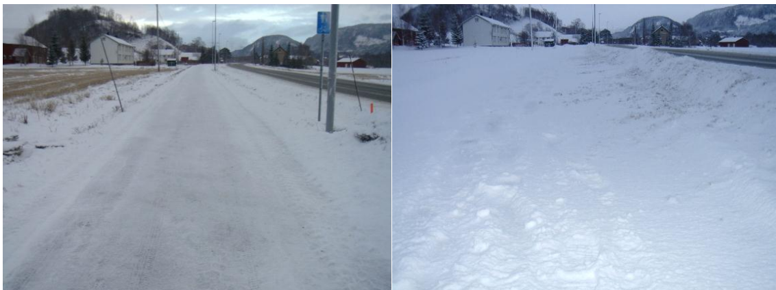
Figur 7-13 Eksempler på godt resultat (til venstre) og dårlig resultat (til høyre) etter brøyting av både hovedveg og g/s-veg
