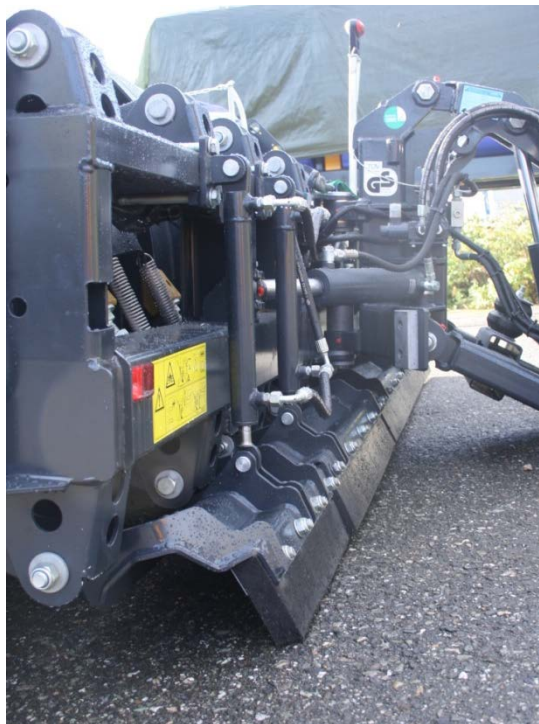
Figur 4-26 Gummiskjær/lameller montert bak på plog (kilde: Schmidt Norge AS)
