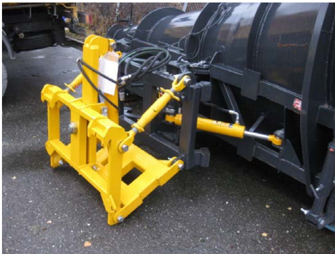
Figur 4-16 Diagonalplog med hydraulisk skråstilling (kilde: GMI)
