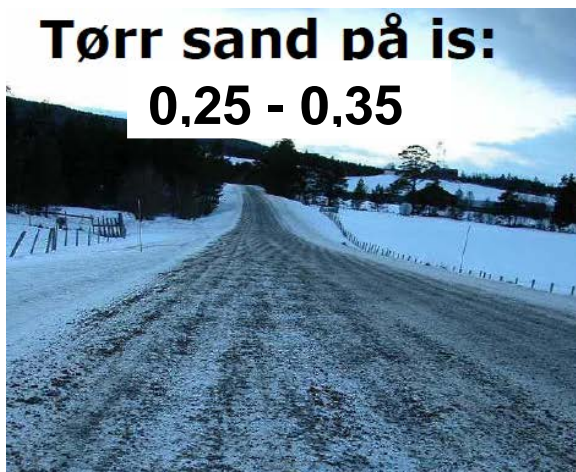
Figur 5-4 Friksjon på veg med isdekke strødd med sand og fastsand
