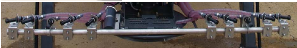
Høyhastighetsspredning med tallerken og dyser
