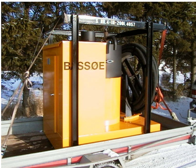
Figur 7-17 Stasjonært tineutstyr montert på tilhenger (Kilde: Glomsrød Mek. Verksted)
