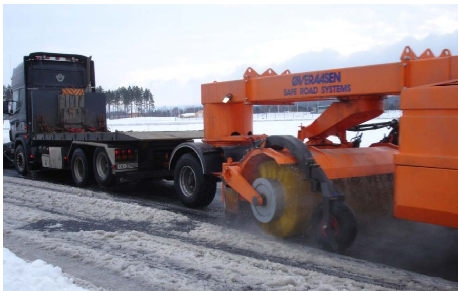
Figur 4-27 Etterhengende sweeper (kilde: Øveraasen)
