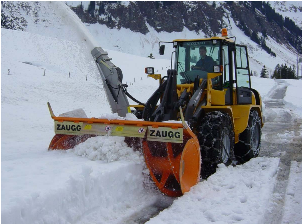
Figur 4-10 Mindre hjullaster med snøfreser for GS-veger (kilde: Volvo Maskin)
