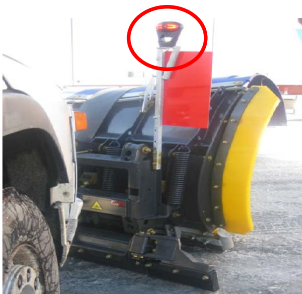
Figur 4-7 Markeringslys og merking bak på plog
