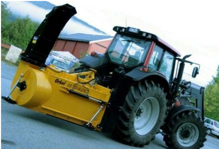
Figur 4-29 Bakmontert snøfres på traktor (kilde:Orkel AS)
