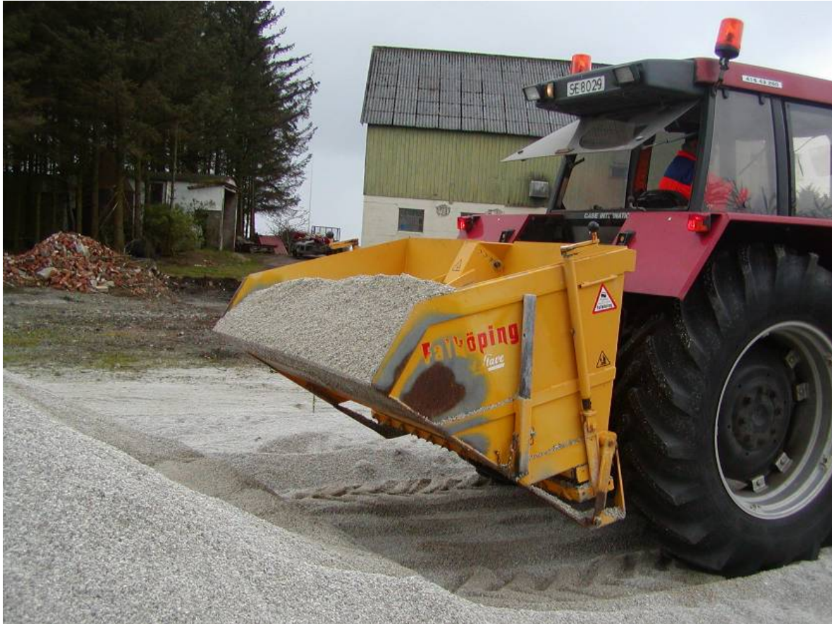
Figur 5-16 Bakmontert strøapparat for traktor
