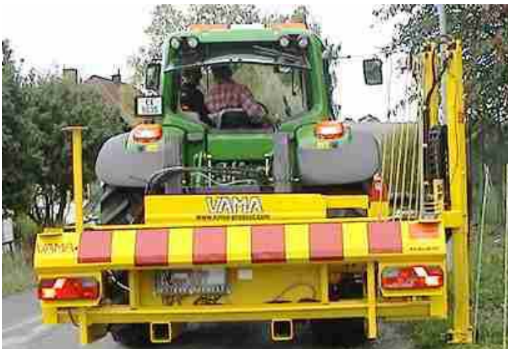
Figur 7-21 Utstyr for utsetting av brøytestikk montert på traktor (Kilde: Torp Maskin AS)
