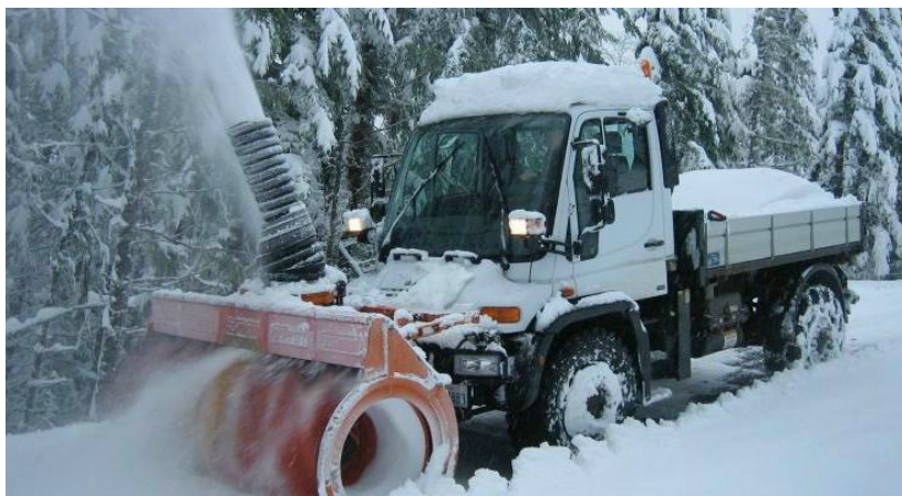
Figur 4-12 DB Unimog bærekjøretøy (kilde: DB)
