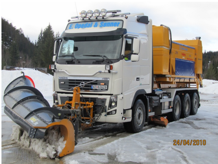
Figur 4-8 Fire-akslet lastebil utstyrt med diagonalplog, underliggende skjær og salt-/sandspreder (kilde: E. Opedal & Sønner)
