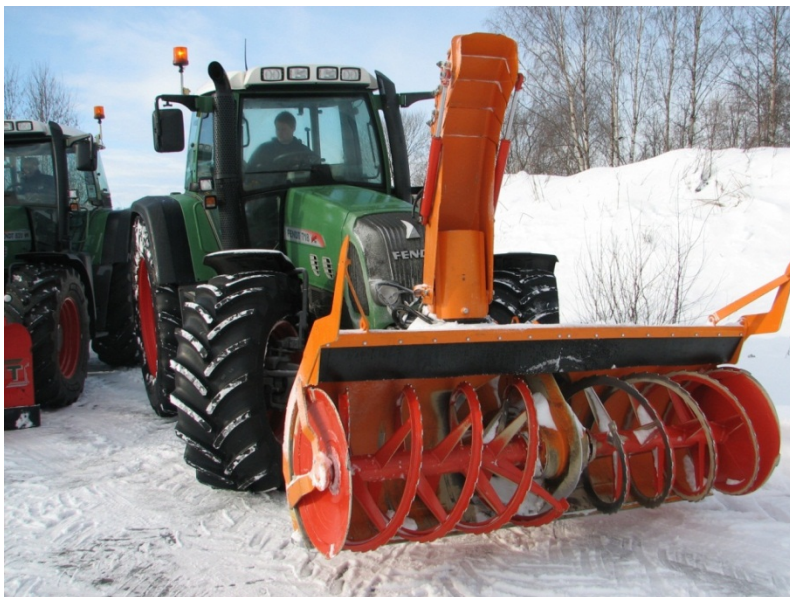
Figur 7-25 Frontmontert snøfres på traktor (Kilde:Tellefsdal)
