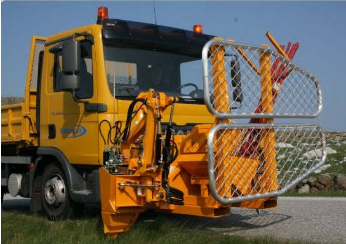
Figur 7-22 Utstyr for utsetting av brøytestikk montert på lastebil (Kilde: S. Risa AS)
