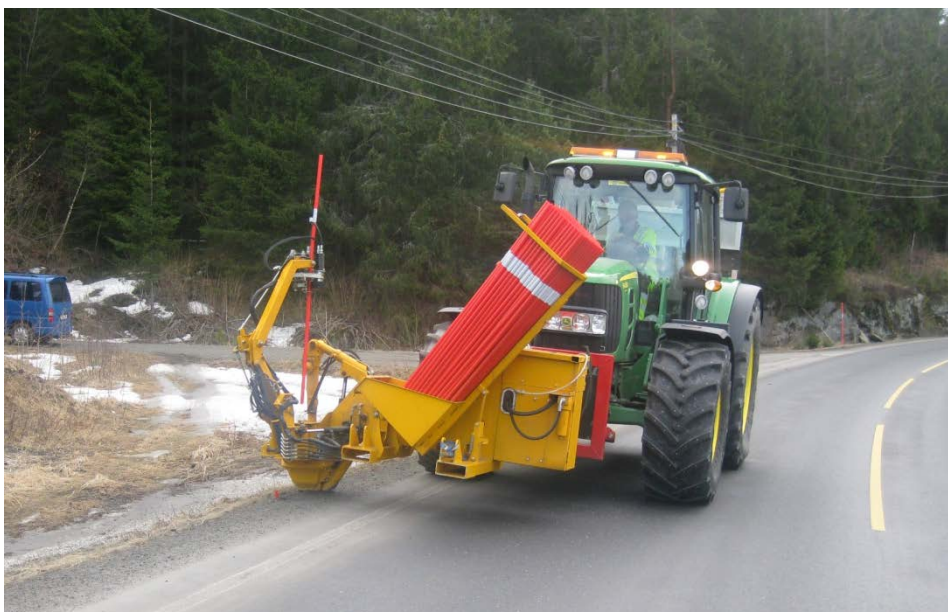
Figur 4-9 Traktor med utstyr for nedsetting av brøytestikk (kilde: RISA AS)
