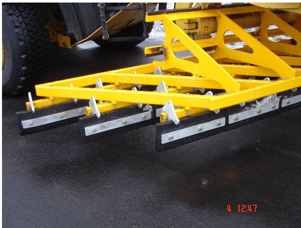
Figur 4-28 Slapsegrind montert på høvel (Tellefsdal)
