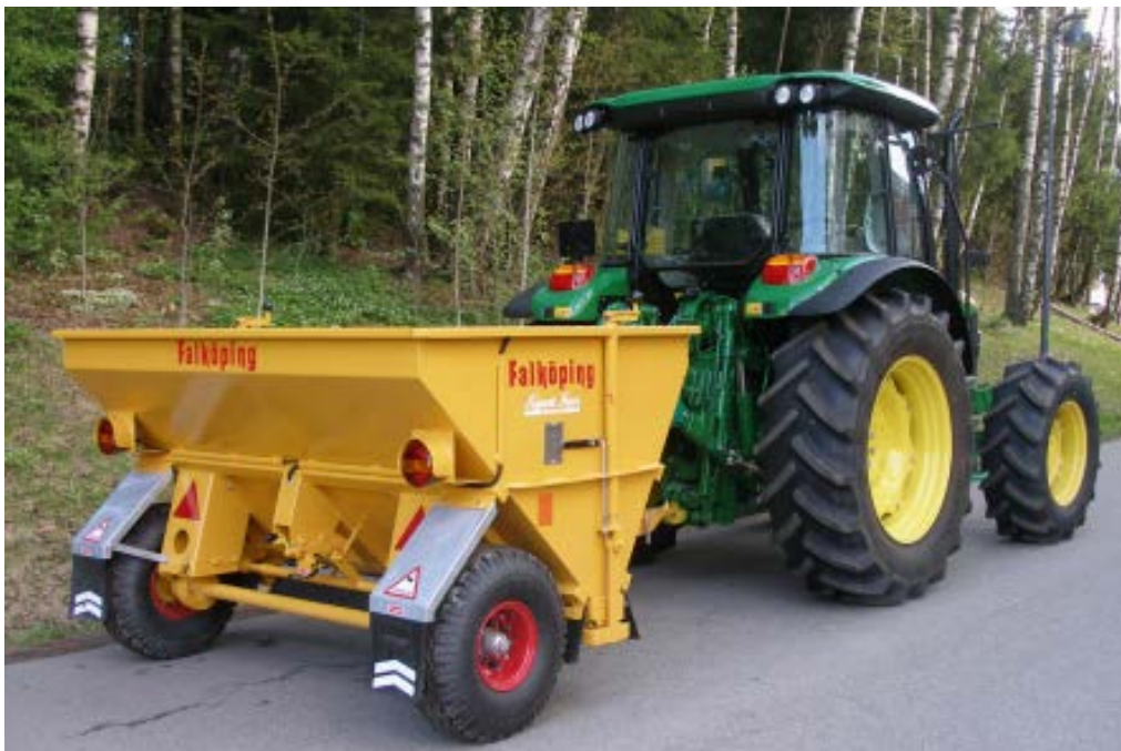
Figur 5-21 Etterhengende strøpparat for traktor
