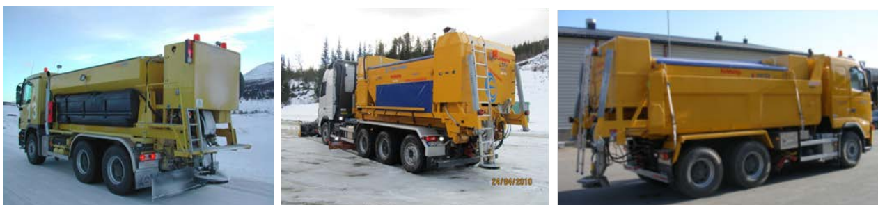
Figur 5-11 Rammemontert, krokløftmontert og planfastspent strøapparat
