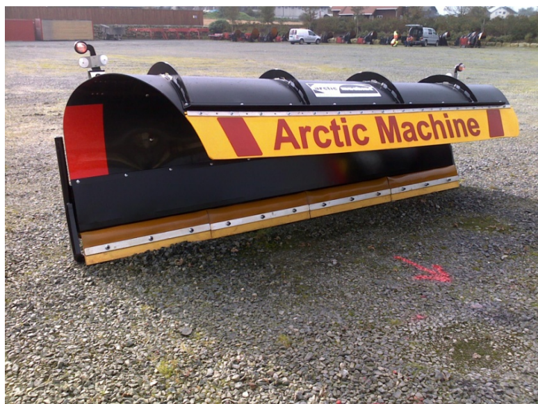
Figur 4-17 Kombinasjonsplog med plogblad av plastmateriale (kilde: Arctic Machine)
