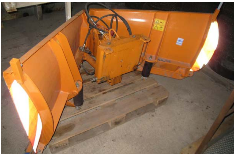
Figur 4-32 Plog egnet for arbeid på gang- og sykkelveger
