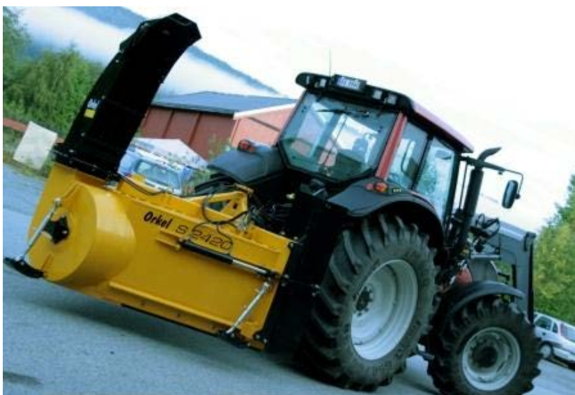
Figur 7-26 Bakmontert snøfres på traktor (Kilde:Orkel AS)
