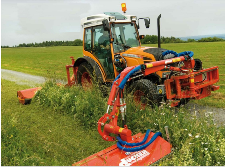
Figur 4-33 Smalsporet traktor egnet for arbeid på gang- og sykkelveger (kilde: EIK)
