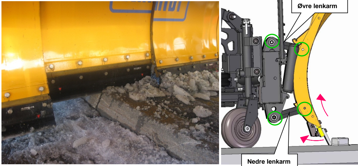
Figur 4-21 Bevegelige plogseksjoner på fortauskant (kilde: Schmidt Norge AS)
