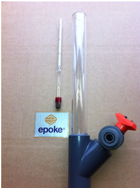
Figur 6-7 Utstyr for måling av saltkonsentrasjon (kilde: Epoke)
