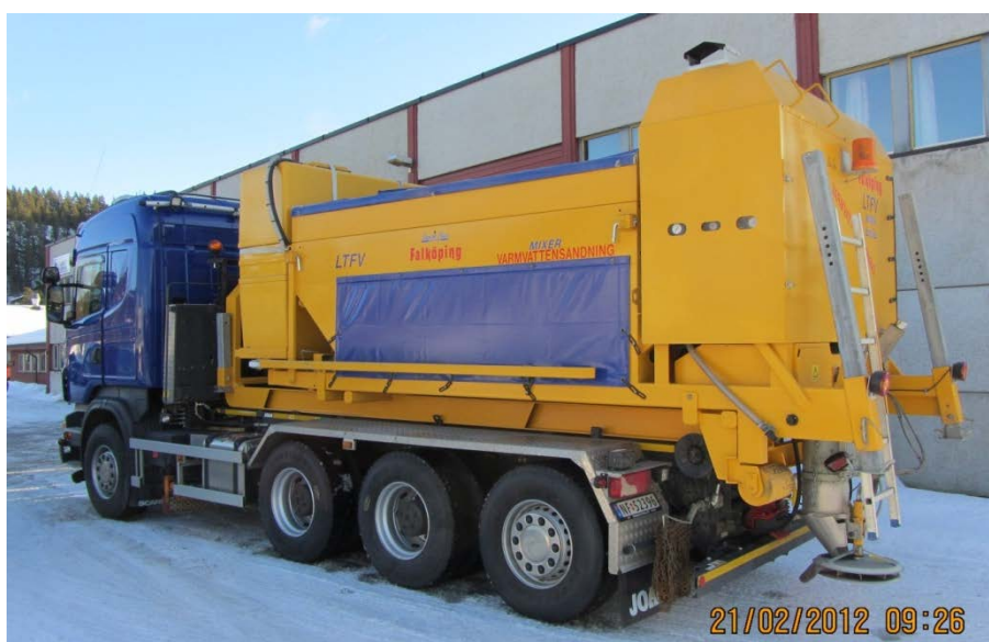
Figur 5-13 Fastsandspreder kan også brukes som saltspreder for befruktning med varmt vann
