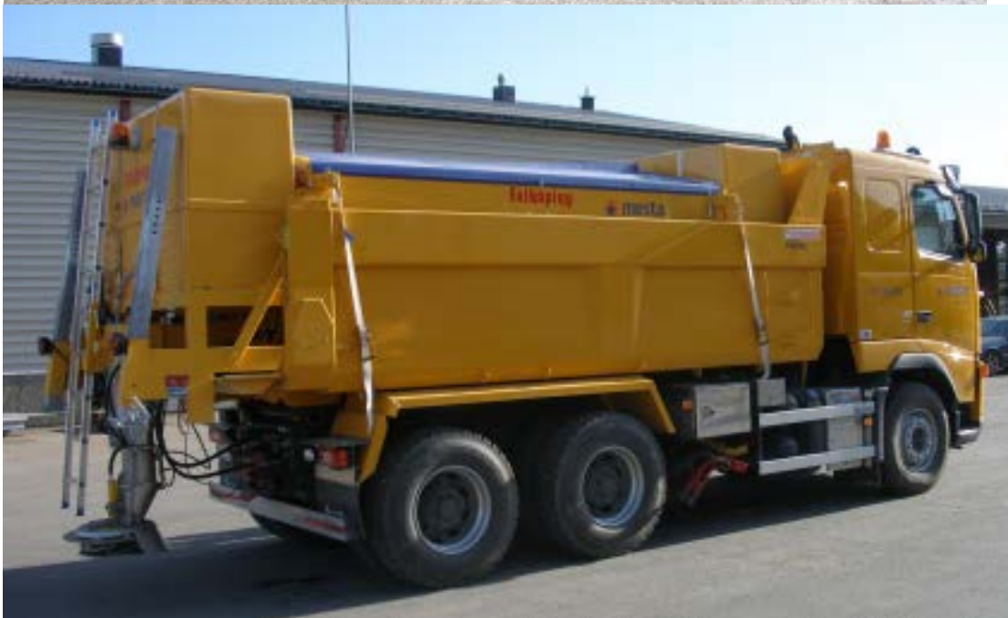
Figur 5-22 Eksempler på bærekjøretøy for sanding og salting.
