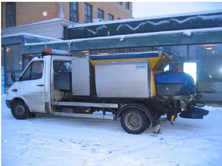
Figur 5-19 Kjøretøy for fastsandspredning på gang- og sykkelveger
