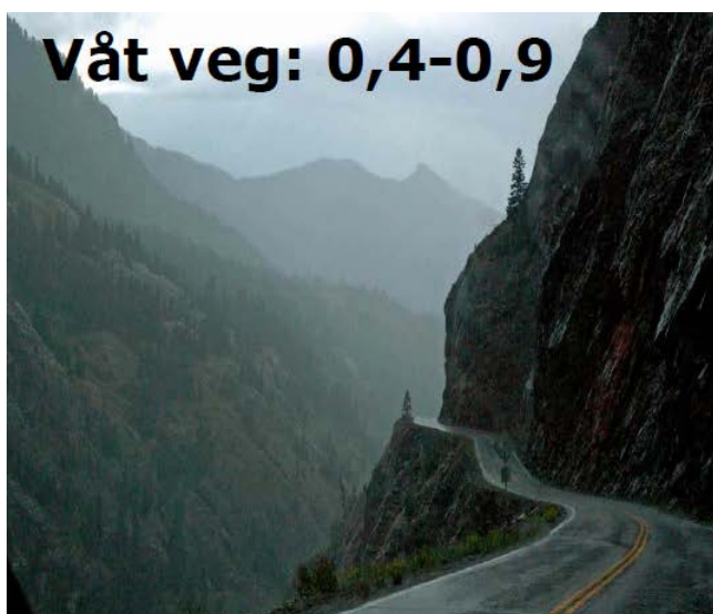
Figur 5-5 Friksjon på våt og tørr asfalt
