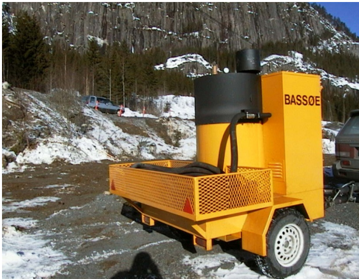
Figur 7-18 Mobilt tineutstyr med tilhengerunderstell (Kilde: Glomsrød Mek. Verksted)
