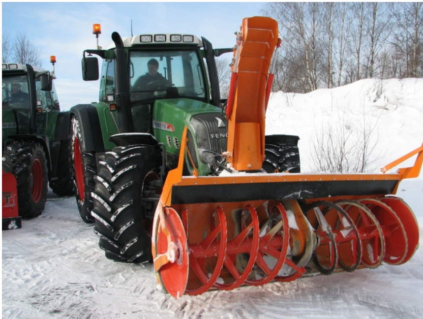
Figur 4-30 Frontmontert snøfres (kilde:Tellefsdal)
