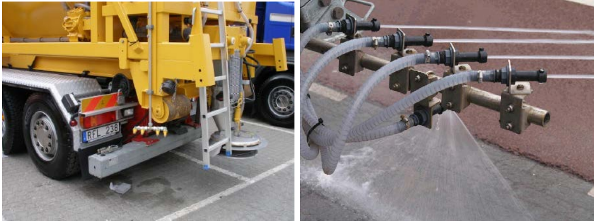
Figur 5-15 Strøpparat for høyhastighetsspredning (kilde: Falköping til venstre og epoke til høyre).
