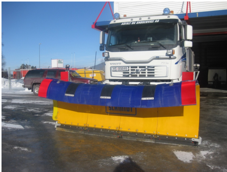
Figur 4-20 Seksjonsoppdelt plog (kilde: Schmidt Norge AS)
