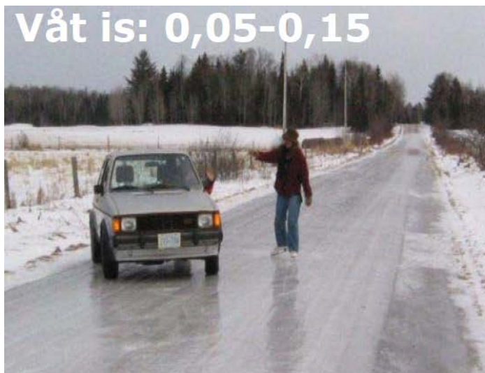
Figur 5-3 Friksjon på våt og tørr is
