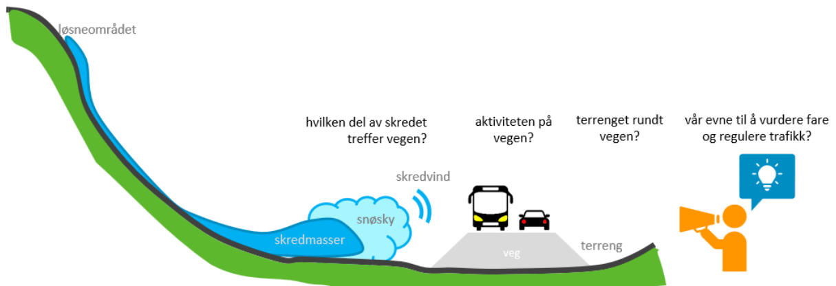
Figur 15: Noen elementer som påvirker hvilken skade et skred kan gjøre på veg og vegtrafikk
