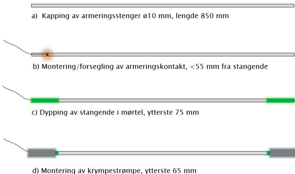
Figur 1 – Produksjon av arbeidselektroder.
