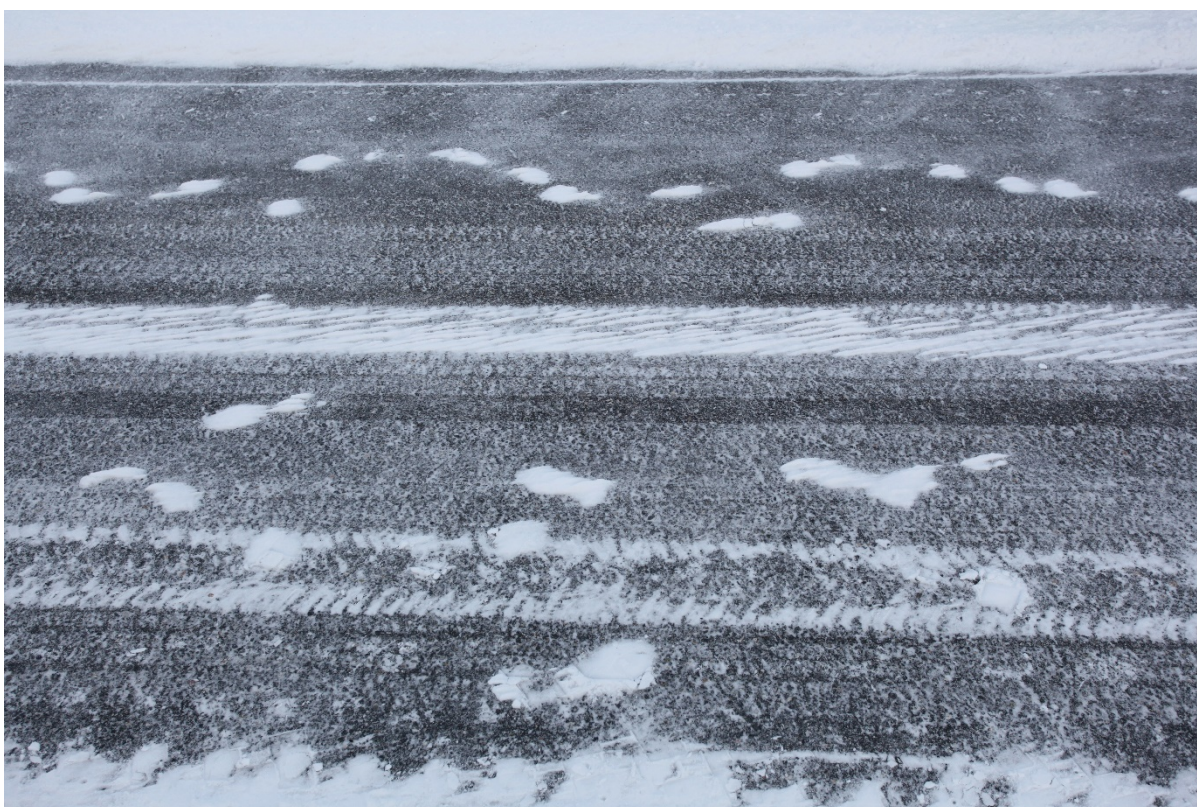
Figur 23: Komprimeringseffekten av syklist, fotgjenger og bil. Resultatet viser at vekten ikke spiller en avgjørende rolle for om snøen blir vanskelig å fjerne eller ikke.
