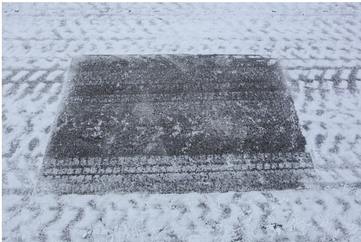
Figur 21: 20 km/t komprimert snø. I ytterkanten av bildet vises det tydelig at resultatet blir dårligere når hastigheten på traktoren øker.
