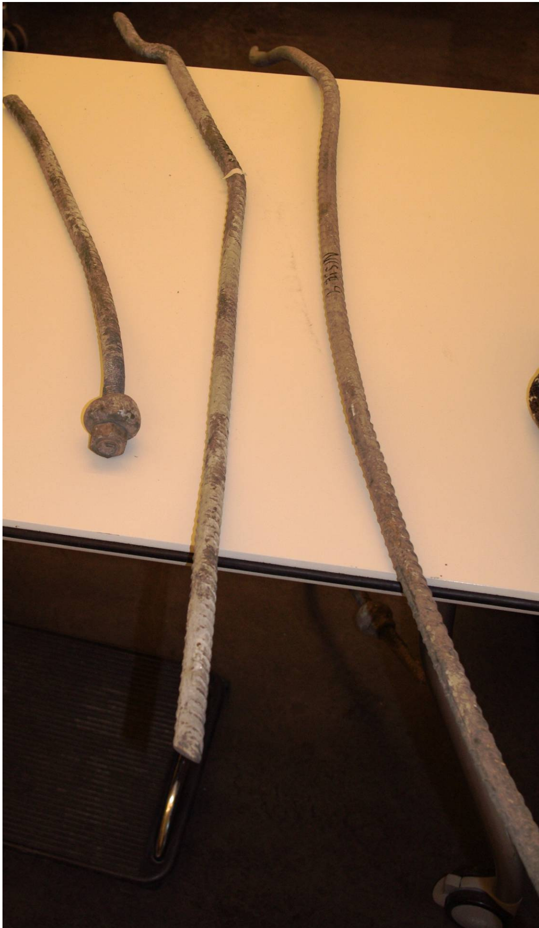
Figur 3.2-1 Frisprengte sikringsbolter fra Øksfjordtunnelen – nisje 4 og 5
