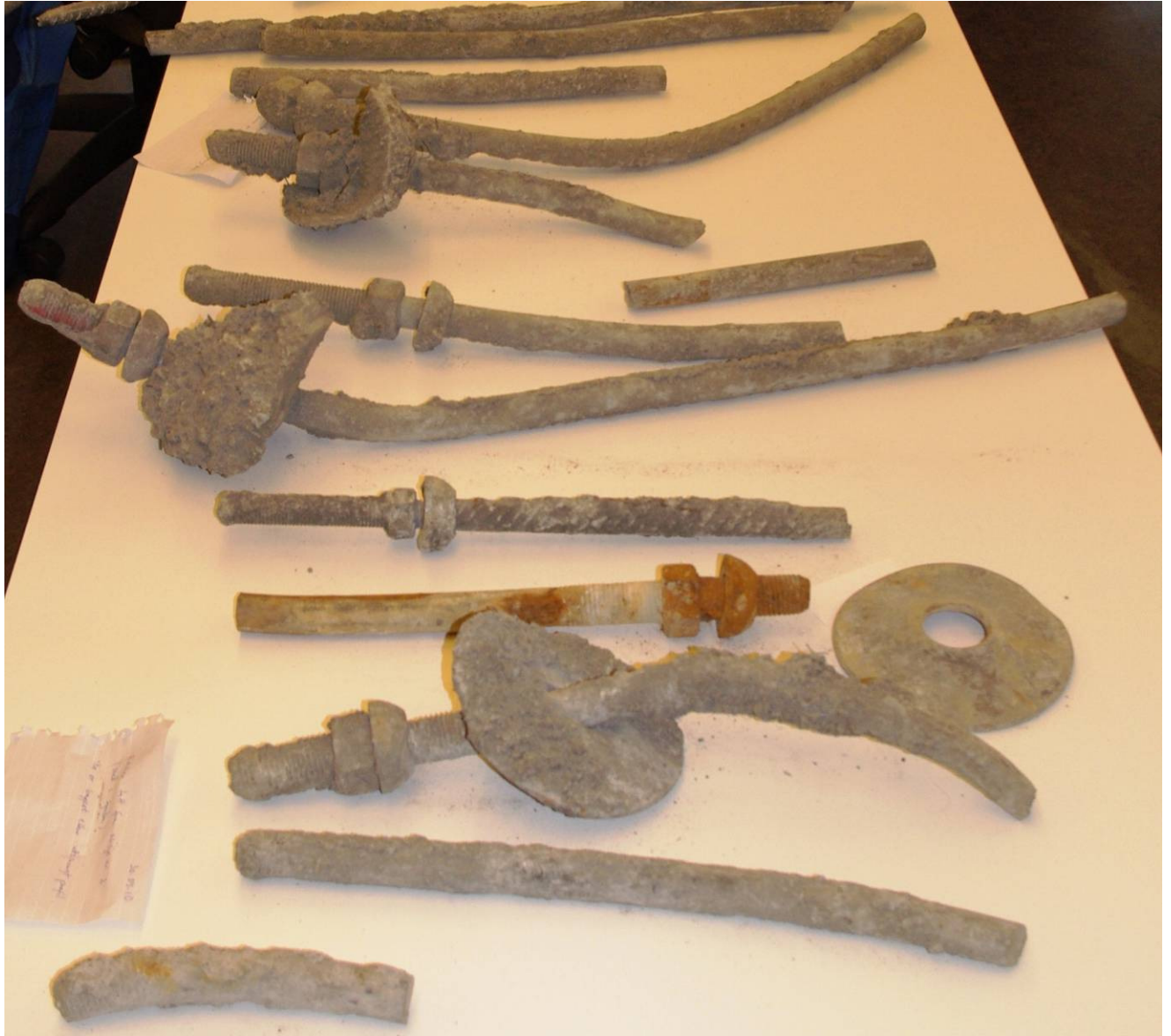
Figur 3.1-1 Frisprengte sikringsbolter fra Kvalsundtunnelen – nisje 1 og 2
