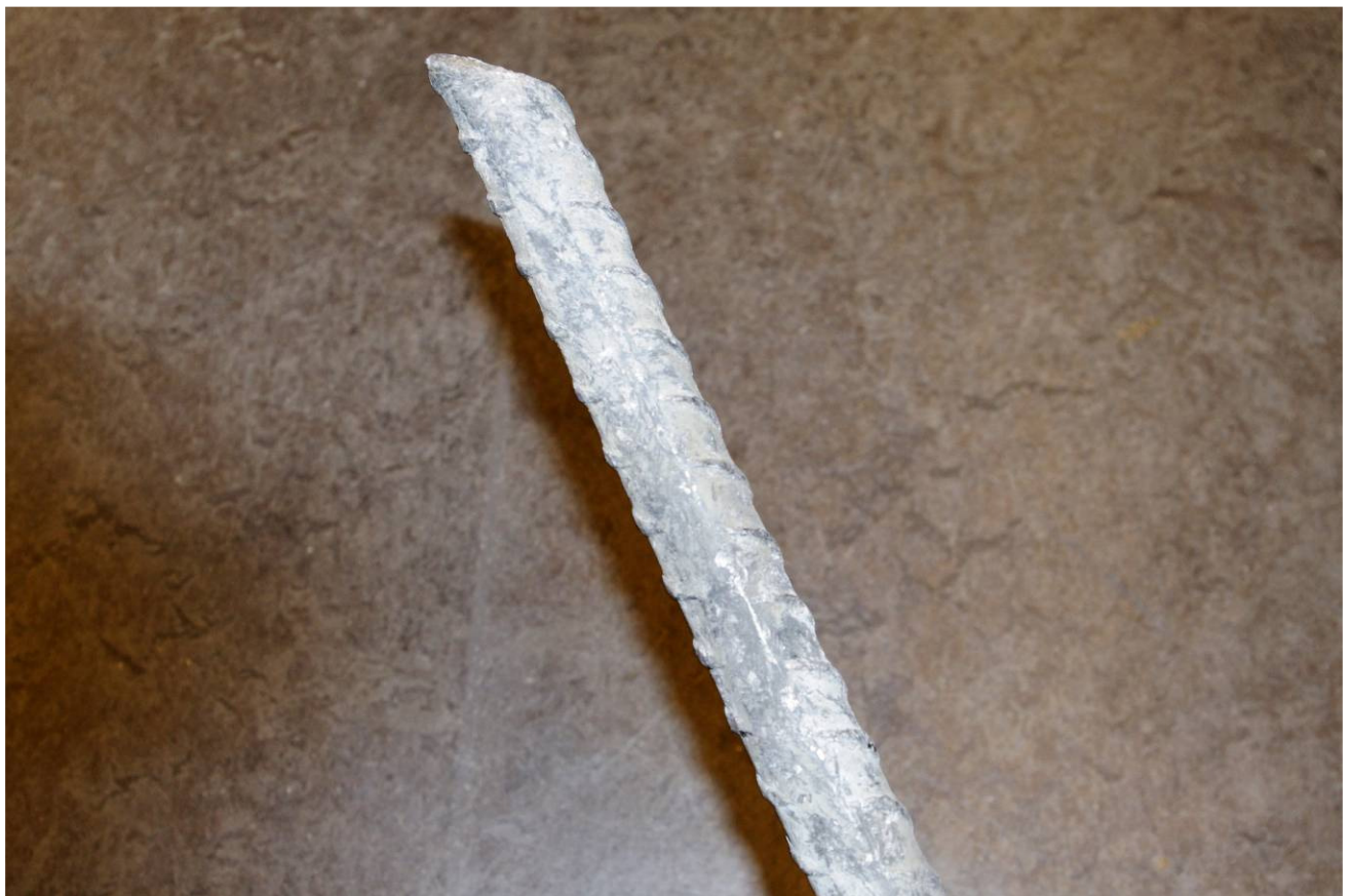
Figur 3.2-5 Frisprengt kamstålbolt med tynn mørtelfilm
