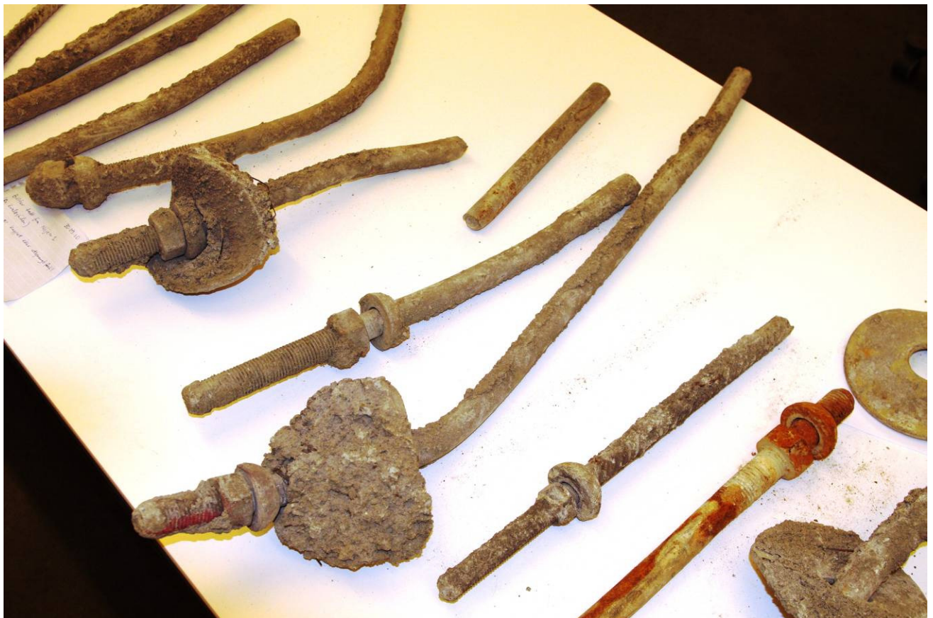
Figur 3.1-3 Frisprengete sikringsbolter fra Kvalsundtunnelen – nisje 1 og 2
