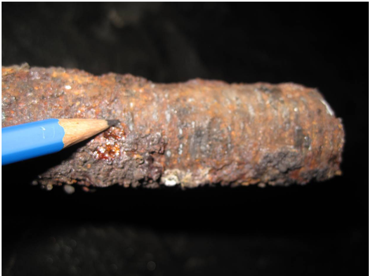
Figur 1.4-16 Bolt 4. Gjenger nesten korrodert bort.
