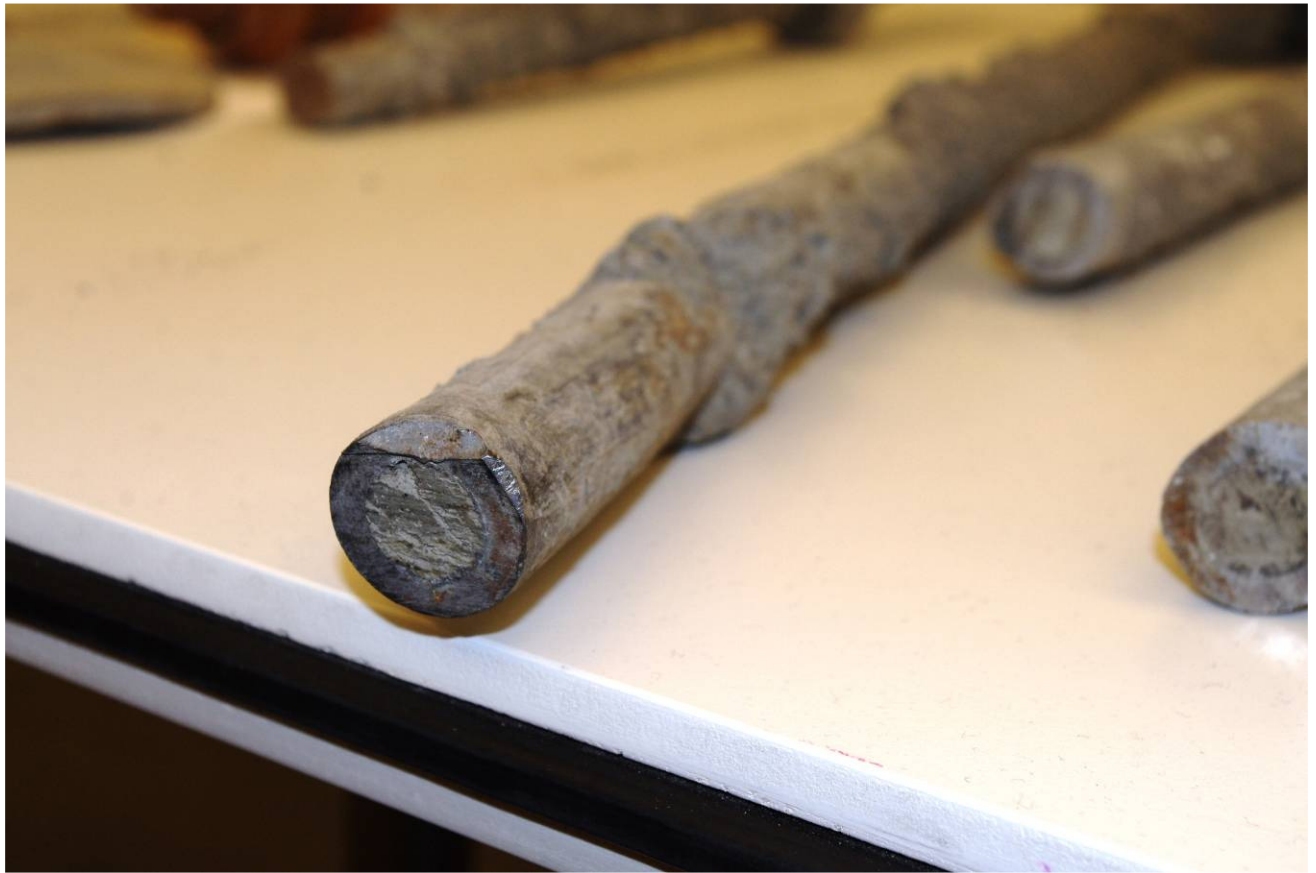
Figur 3.1-6 Gyst rørbolt fra Kvalsundtunnelen
