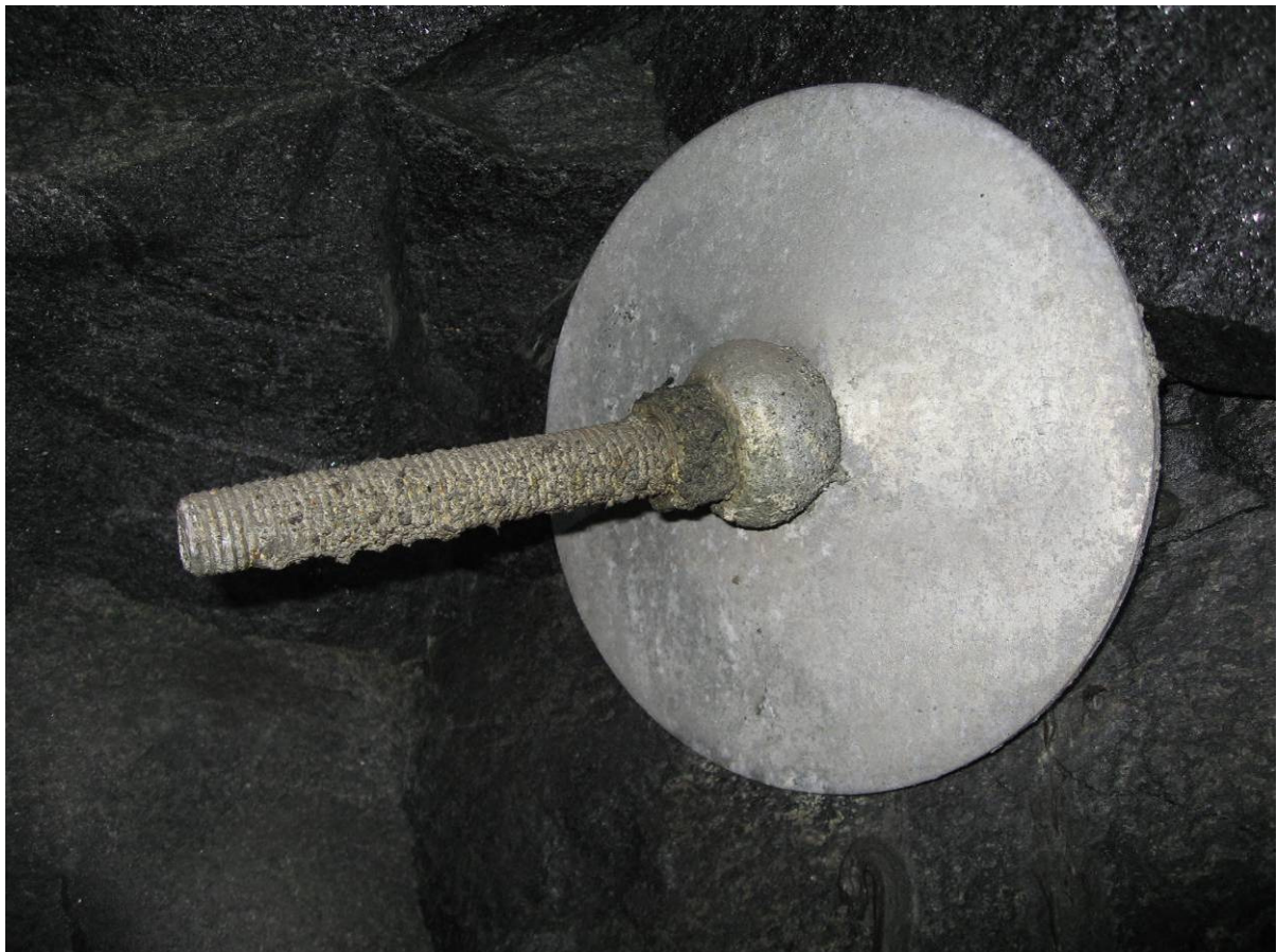
Figur 1.3-8 Gulnet sprøytebetong på bolteende.
