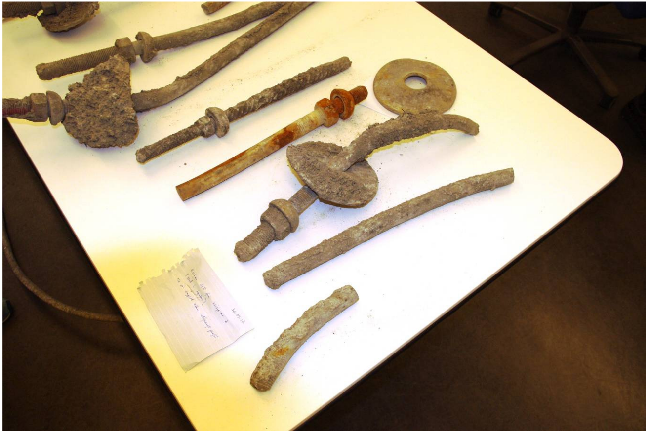
Figur 3.1-2 Frisprengete sikringsbolter fra Kvalsundtunnelen – nisje 1
