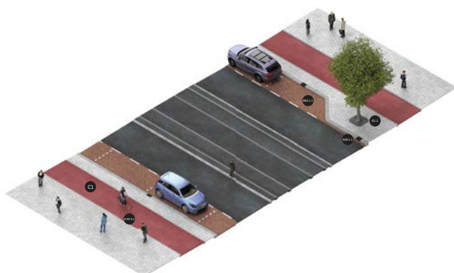
Figur 2.29: Gateeksempel 50 km/t med trikk. Illustrasjon: Gemeente Amsterdam
