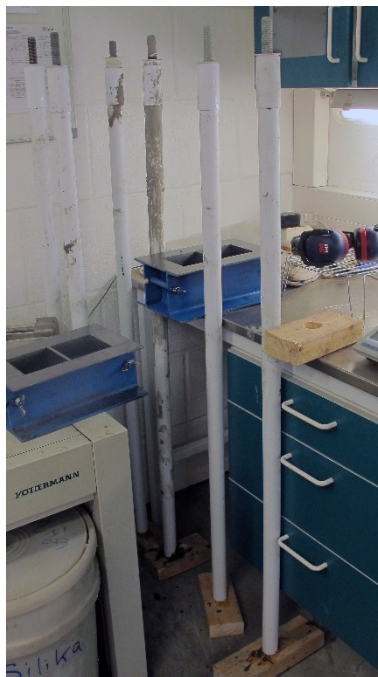
Figur 5 Blanding av boltemørtel og ferdigstøpte bolter som står vertikalt under herding
