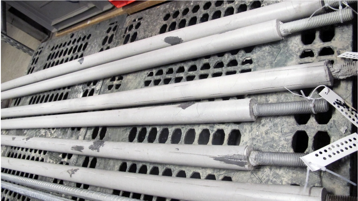
Figur 4 Testbolter omhyllt av mørtel
