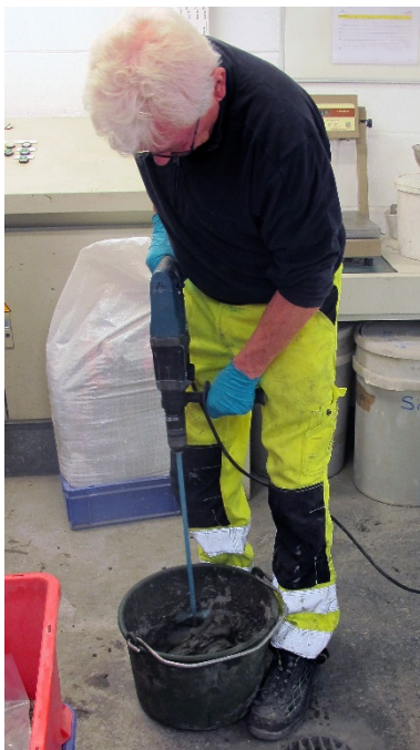
Figur 5 Blanding av boltemørtel og ferdigstøpte bolter som står vertikalt under herding
