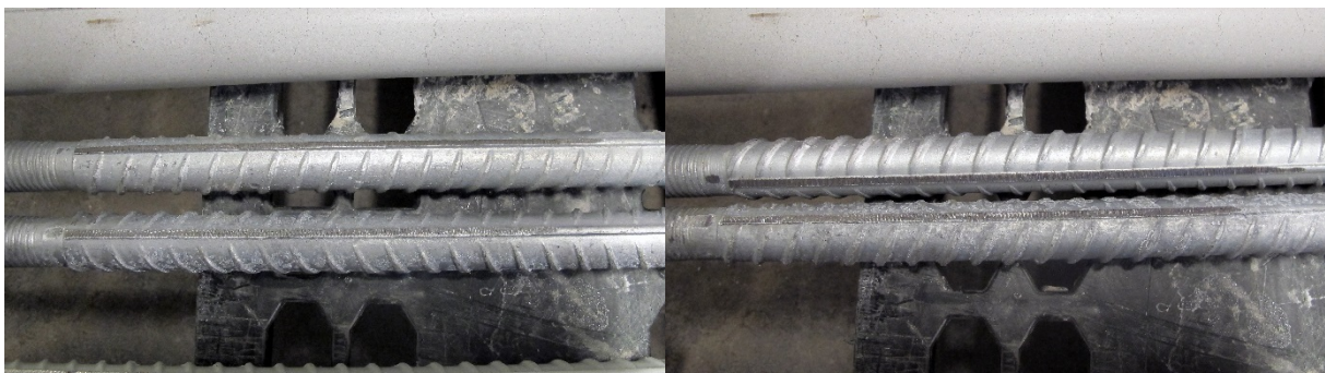
Figur 2 Påført skade i langsgående ribber på varmforsinkede bolter
