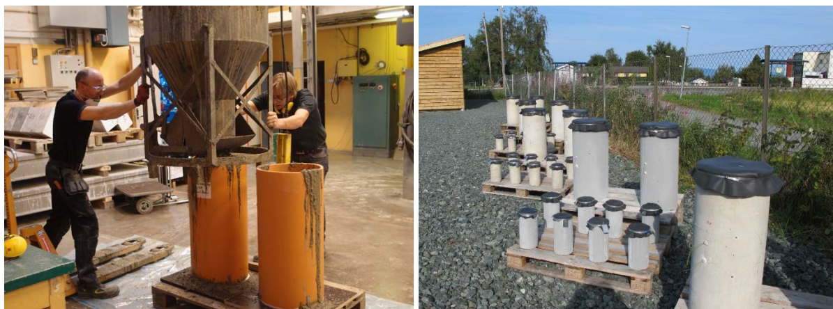
Bildet til venstre viser utstøping av store sylindre med alkalireaktiv betong (foto: Ola Skjølsvold, SINTEF), mens bildet til høyre viser store og små sylindre utplassert på SINTEFs felstasjon i Trondheim (foto: Eva Rodum)
