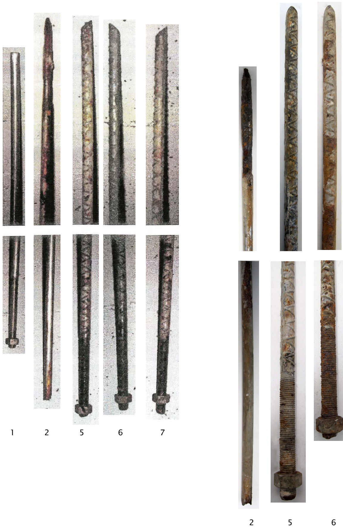
Figur 1 Bolt nr. 1, 2 (rustfrie kvaliteter) og 5-7 (kamstålbolter) i 1992 t.v. [1], bolt nr. 2, 5 og 6 i 2011 t.h.
