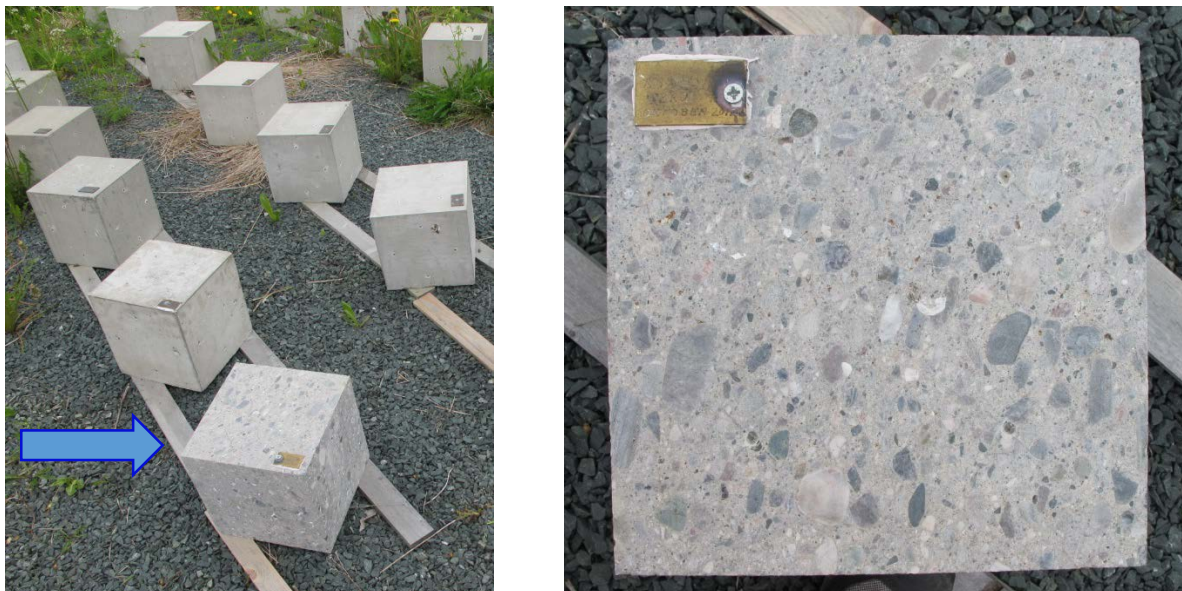
Figur 5 Til venstre foto av kuber eksponert på SINTEF's feltstasjon på Voll i Trondheim, tilsaget kube fra Nautesund merket med pil. Til høyre ses toppflata av kuben med messingskilt inngravert «Nautesund bru Oktober 2012»
