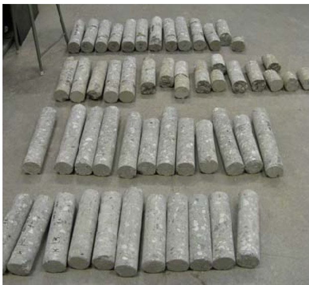
Figur 8 Utborede kjerner for de fire betongene i Runde 2
