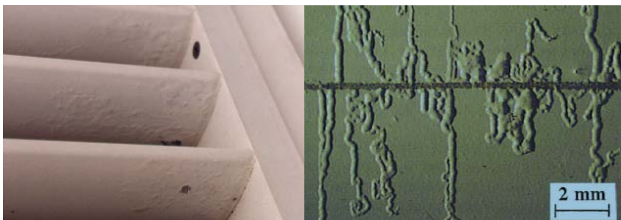
Figur 10. Filiformkorrosjon på lakkert aluminium. Fra virkeligheten til venstre og på en labprøve til høyre (Foto: SINTEF).
