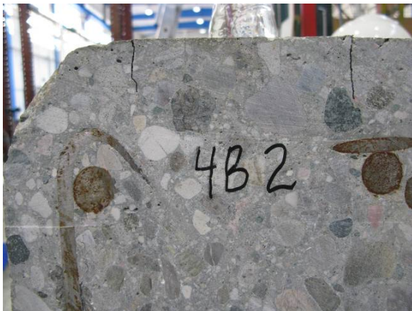
Element 4B – endeflate A (2). Nærfoto av armeringsender
