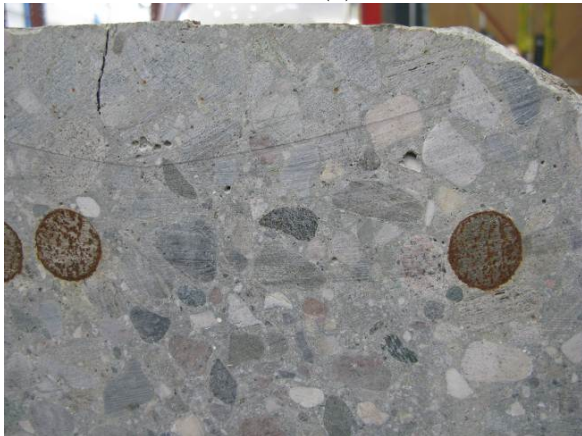
Element 4B – endeflate A (2). Nærfoto av armeringsender
