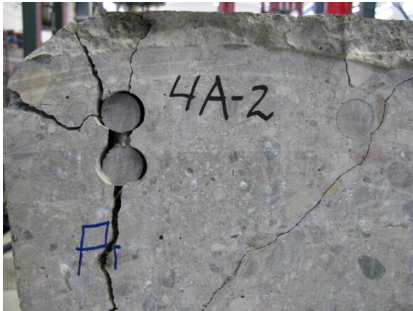
Element 4A – endeflate A (2). Nærfoto av armeringsender
