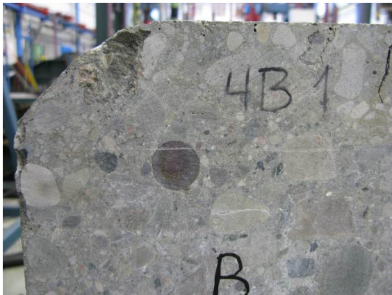
Element 4B – endeflate B (1). Nærfoto av armeringsender
