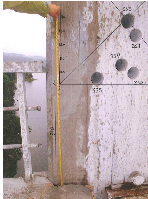
Figur 12 Foto som viser prøvelokaliteter på tårnsøyler i akse 3, nordre søyle til venstre og søndre søyle til høyre. Avstand fra kantbjelke til origo av referansefelt (ORI) og kjernemerking er angitt. Foto: Audun E. Sanda, Statens vegvesen
