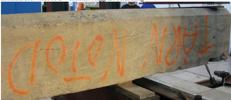
Element 3A – side B-A – montert i rigg før belastning
