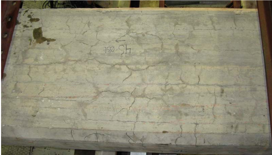
Element 4A – toppflate A-B – montert i rigg før belastning
