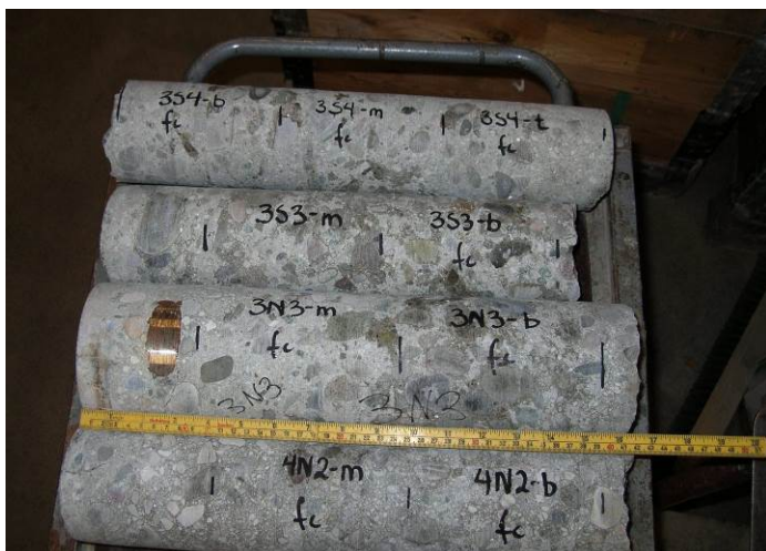
Figur 45 Kjerner merket for tildanning av prøvestykker for trykkfasthetsprøving
