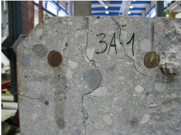
Element 3A – endeflate A (1). Nærfoto av armeringsender
