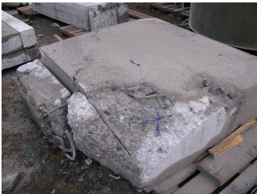
Figur 66 Øvre del av rigel sagt fra for visuelle undersøkelser
