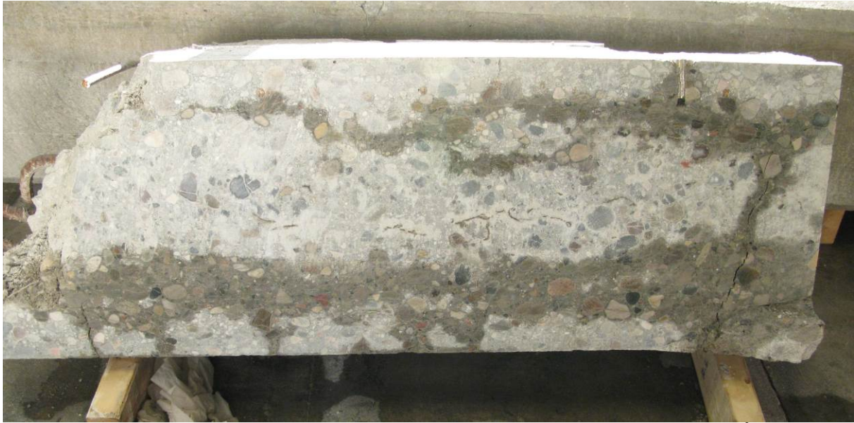
Figur 74 Horisontalsnitt etter saging av øvre del av rigel i akse 4, b \times l = 0,4 \times 1,0 \text{ m}^2
