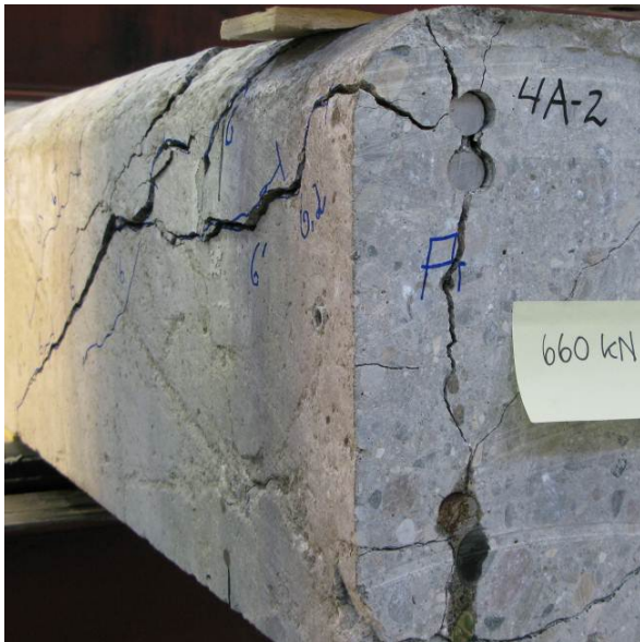
Endeflate A. Armeringsender i hhv venstre og høyre side
