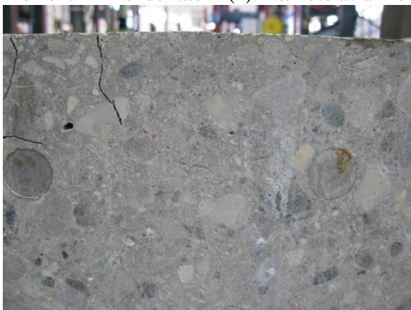
Element 4A – endeflate A (2). Nærfoto av armeringsender
