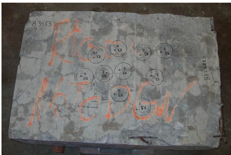
Figur 65 Lokaltet og merking av kjerner boret fra rigel i akse 3, flate mot vest. Påtegnede piler markerer retning mot toppen av rigel
