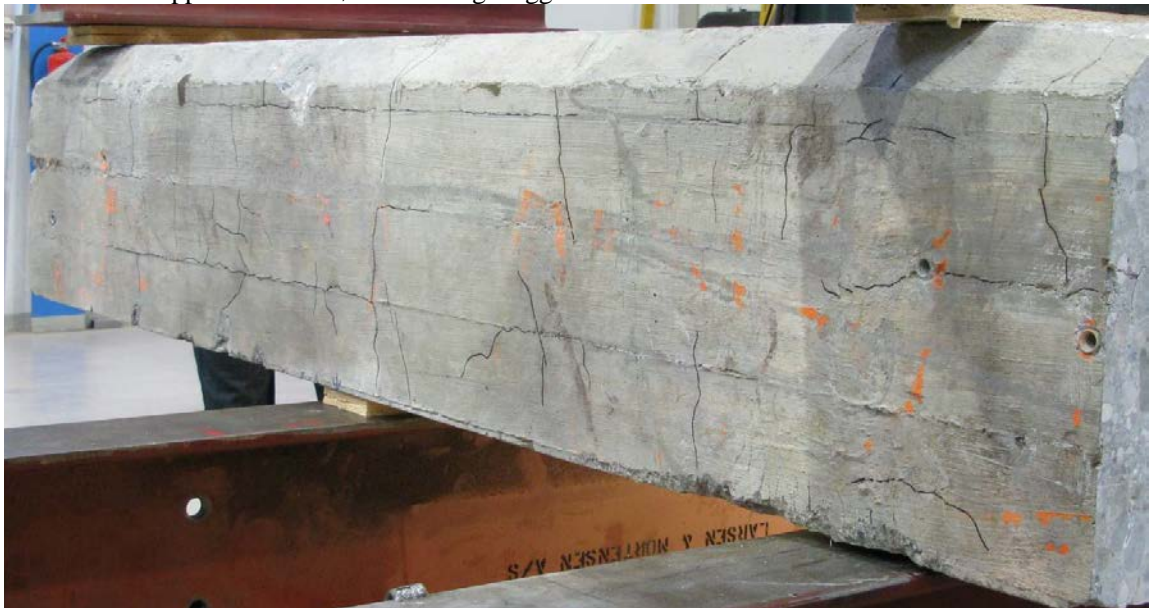
Element 4B – side A-B – montert i rigg før belastning
