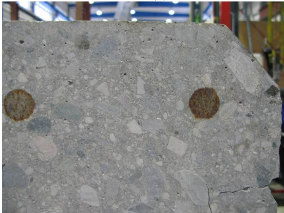
Element 3A – endeflate A (1). Nærfoto av armeringsender
