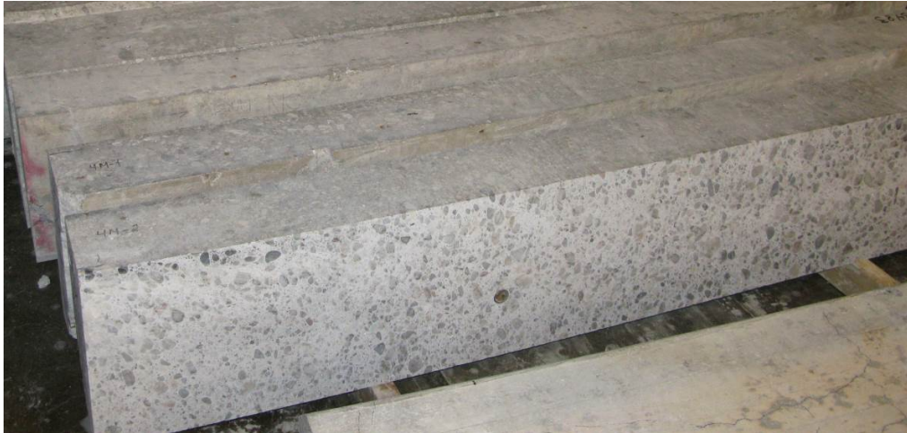
Figur 67 Prismer tildannet for eventuell heftprøving, mrk 4M-1 og 4M-2, fra tårnelement 4M (midtstykket). Ble senere kastet.
