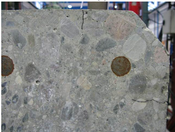
Element 3A – endeflate B (2). Nærfoto av armeringsender
