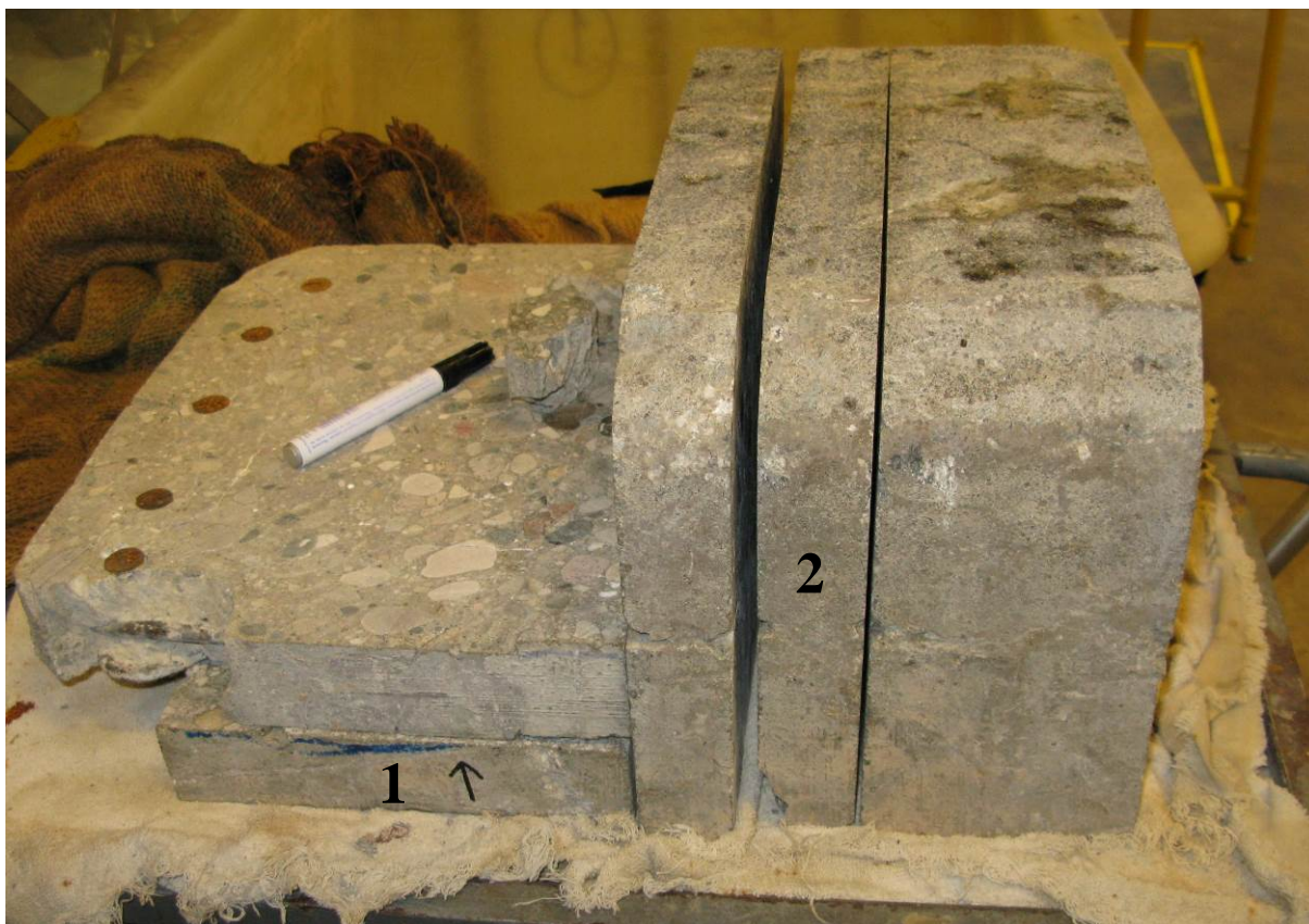
Figur 76 Skiver tildannet fra topp rigel akse 4, iht skisse i Figur 71. Horisontal skive merket 1 og vertikal skive merket 2
