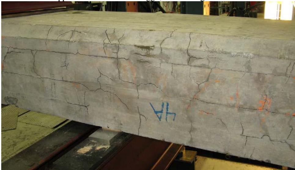
Element 4A – side A-B – montert i rigg før belastning
