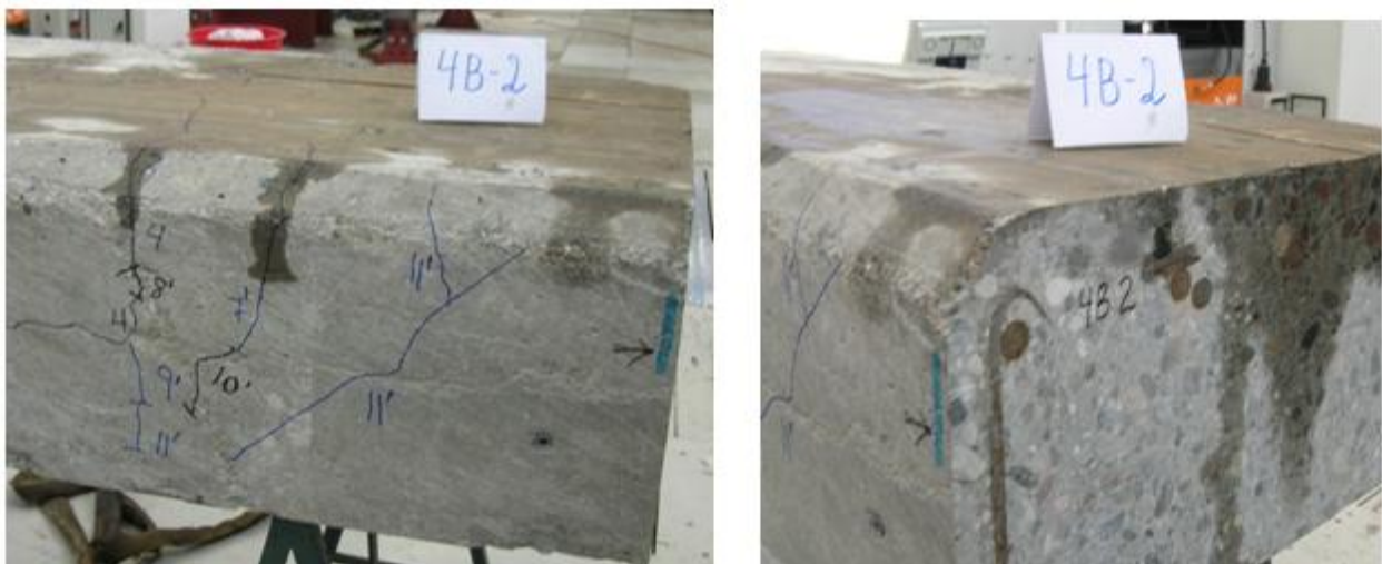
Figur 10.47 Skråriss og armeringstilstand ved endeflatten for Element 4B, Ende A ved P=1100 kN (Lasttilfelle 2). Foto: Hans Stemland, SINTEF
