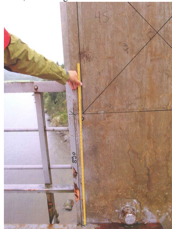
Figur 13 Foto som viser prøvelokaliteter på tårnsøyler i akse 4, nordre søyle til venstre og søndre søyle til høyre. Avstand fra kantbjelke til origo av referansefelt (ORI) og kjernemerking er angitt. Foto: Audun E. Sanda, Statens vegvesen
