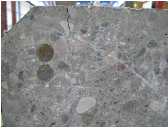
Element 4A – endeflate B. Nærfoto av armeringsender
