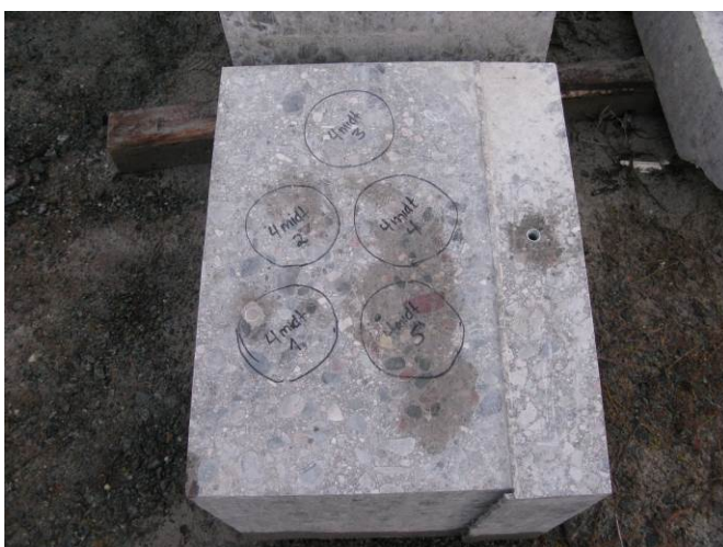
Figur 63 Lokalitet og merking av kjerner boret fra tårnelement 4M (midtstykket)
