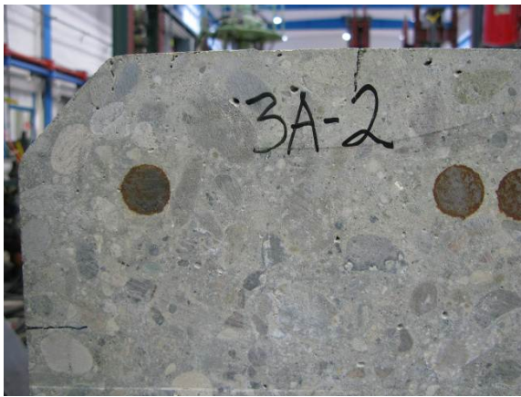
Element 3A – endeflate B (2). Nærfoto av armeringsender
