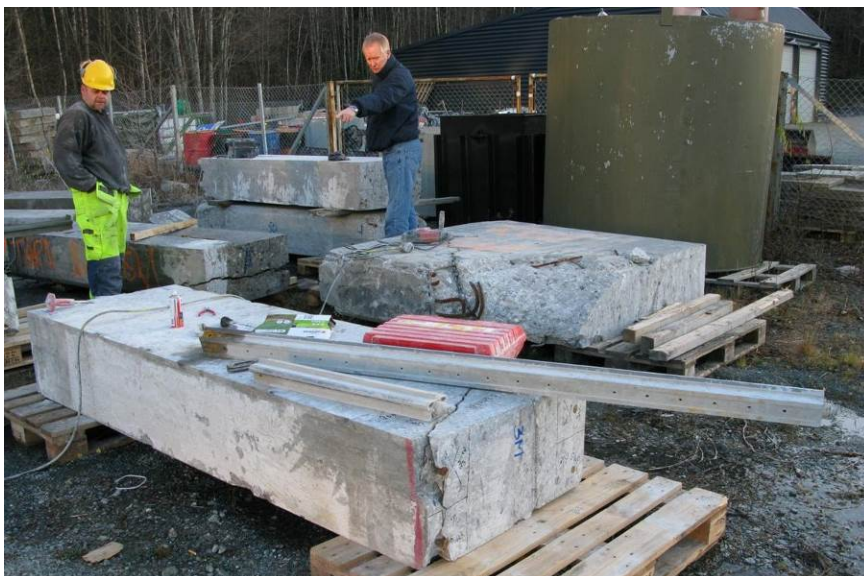
Figur 62 Tilsaging av prøvestykker for belastningsprøving og eventuell heftprøving
