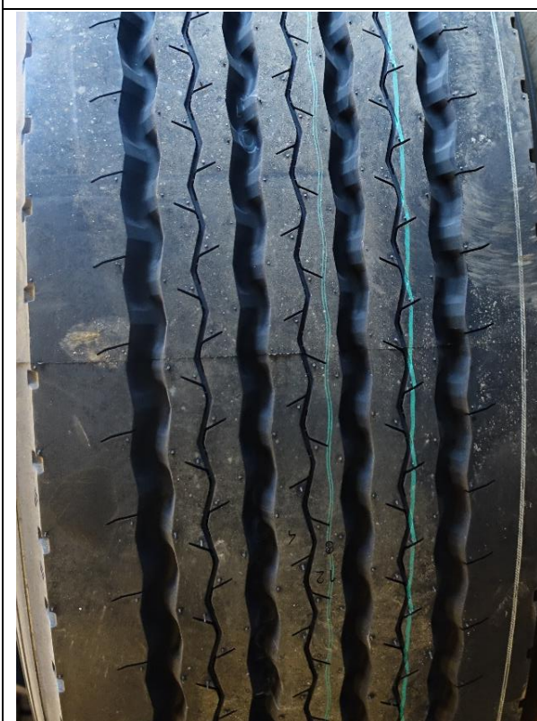
Dag 1 – kombinasjon nr. 5. Rullemonster styr, kontinentalt monster (grov knastet) driv. Nye/ubrukte u/seip
