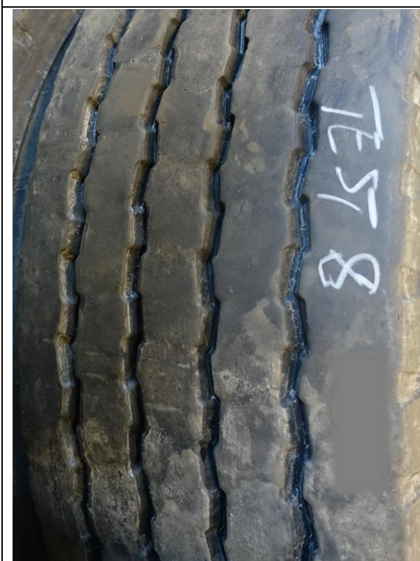
Dag 2 – kombinasjon nr. 5. Rullemønster styr, kontinentalt mønster (grov knastet) driv. Halvslitte styr, nye m/seip driv.
