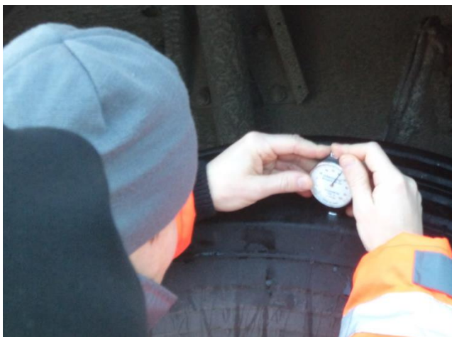
Figur 14: Måling av hardhet med analog shoremåler.
