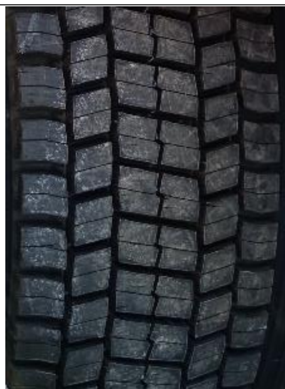
Dag 1 – kombinasjon nr. 4. Knast-/rullemonster styr, knastmonster (grovlamellert) driv. Nye/ubrukte m/seip styr og driv.
