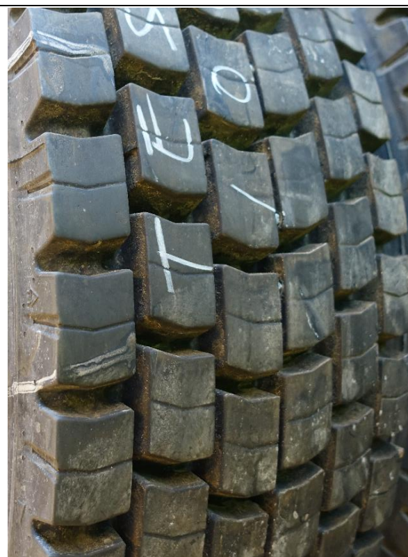
Dag 2 – kombinasjon nr. 4. Rullemønster styr, kontinentalt mønster (grov knastet) driv. Halvslitte styr, nye u/seip driv.
