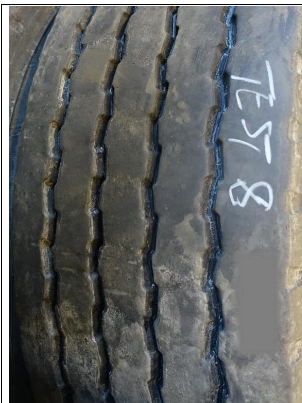
Dag 2 – kombinasjon nr. 4. Rullemønster styr, kontinentalt mønster (grov knastet) driv. Halvslitte styr, nye u/seip driv.
