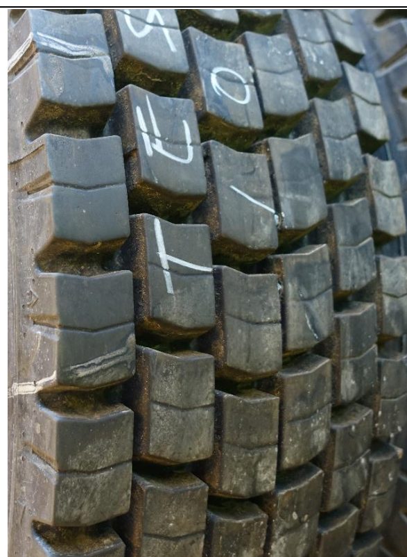
Dag 1 – kombinasjon nr. 5. Rullemonster styr, kontinentalt monster (grov knastet) driv. Nye/ubrukte u/seip
