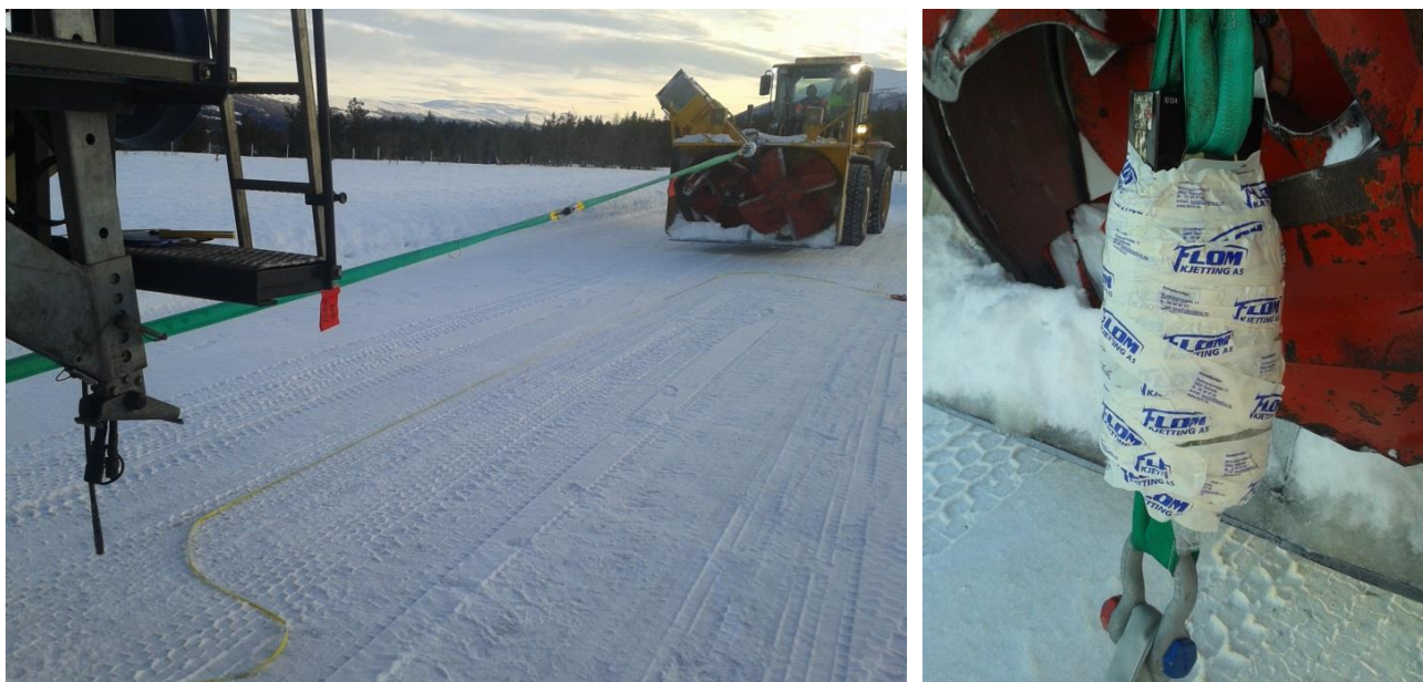
Figur 13: Hjullaster tilkoblet bil i forbindelse med fremkommelighetstesting. Kraftcelle med loggerenhet til høyre.
