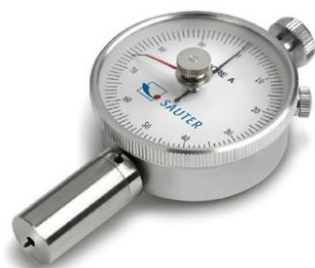
Figur 1: Eksempel på shoremåler til venstre. Prinsippskisse av virkemåte til høyre.
