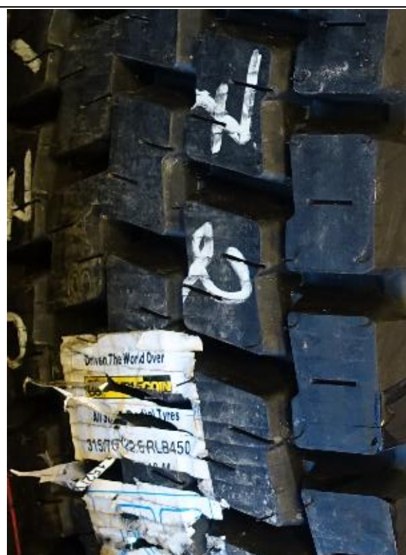
Dag 2 – kombinasjon nr. 5. Rullemønster styr, kontinentalt mønster (grov knastet) driv. Halvslitte styr, nye m/seip driv.
