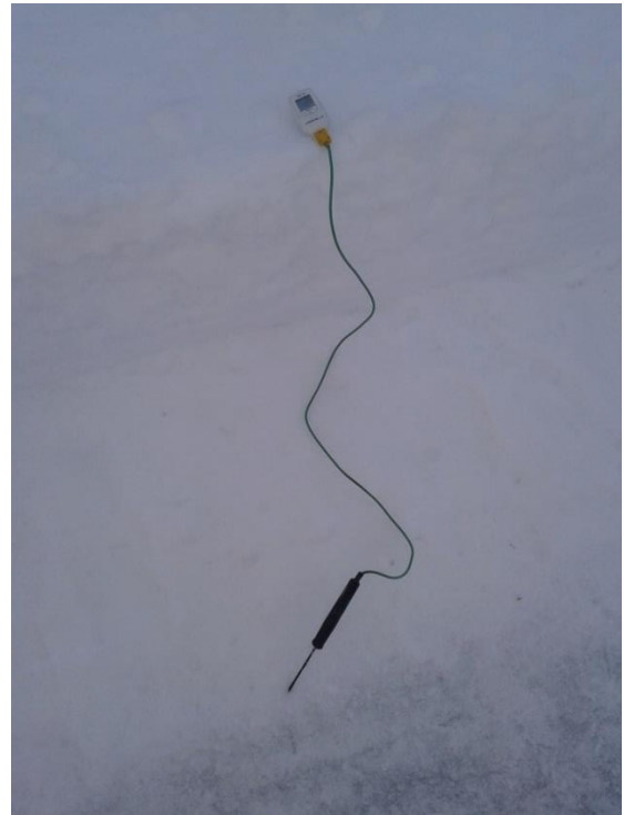
Figur 5: Temperaturmåling (veibanetemp) i felt.
