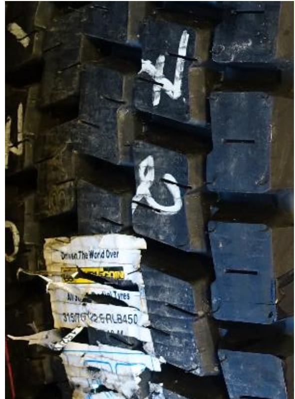
Dag 1 – kombinasjon nr. 6. Rullemønster styr, kontinentalt mønster (grov knastet) driv. Nye/ubrukte m/seip styr og driv.
