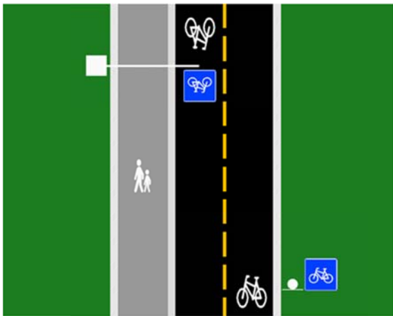
Figur 3.5 Sykkelveg med fortau skiltes med skilt 520 Sykkelveg
