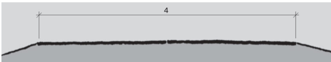
Figur C.23: Tverrprofil A3, 4 m vegbredde (mål i m)
