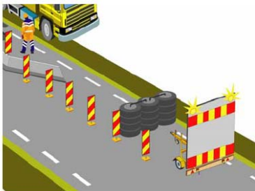
Figur 4. 11: Tversgående sikring på kjørebanen, med varslingsutstyr
