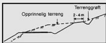
Figur 413.1 Plassering av terrenggrøft
