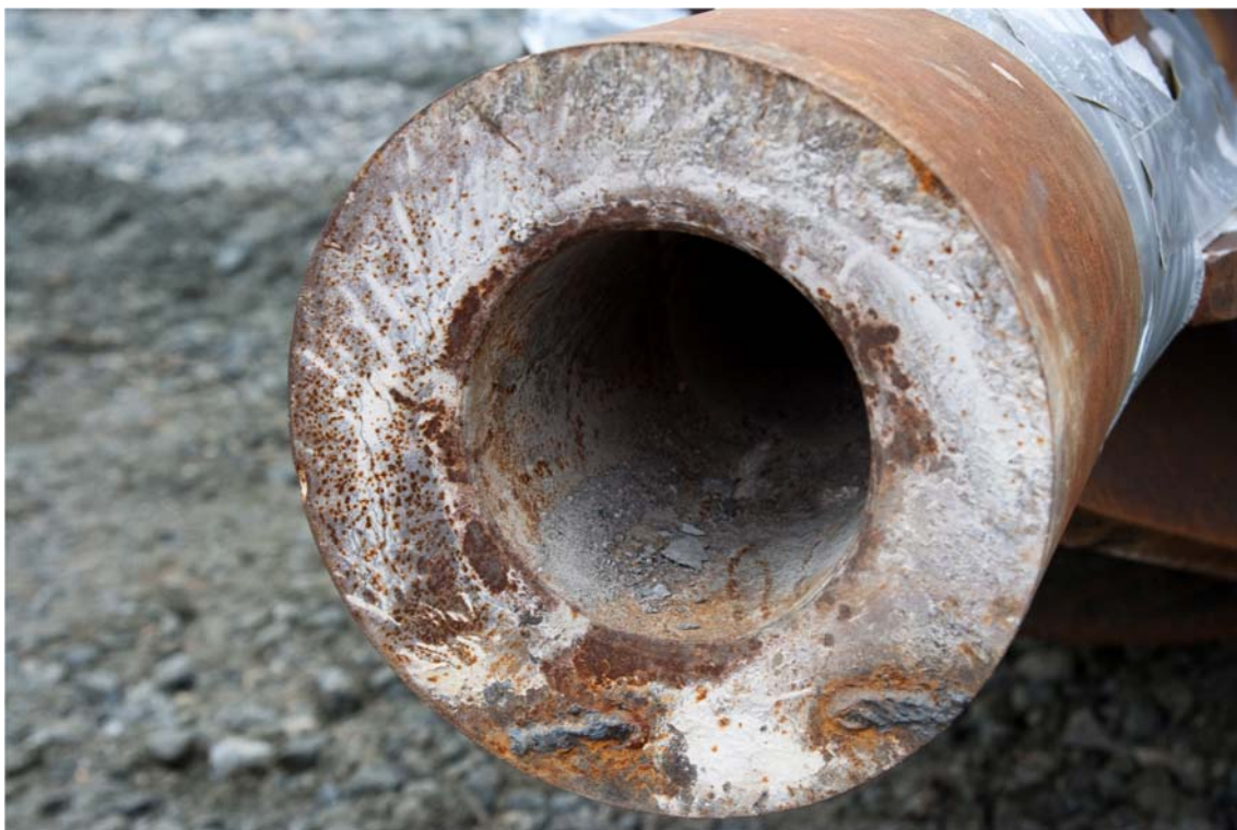
Underkant av spisseømne før spissen ble rammet.
