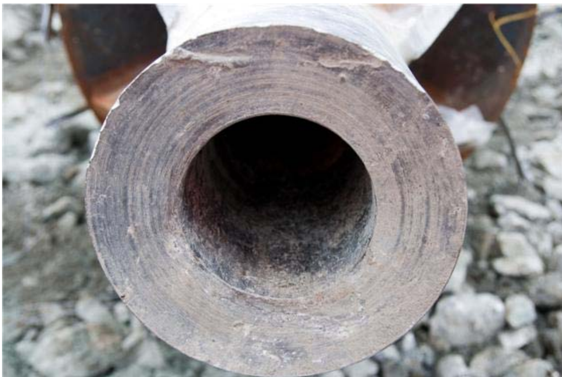
Underkant av spisseemne etter at spissen ble rammet.
