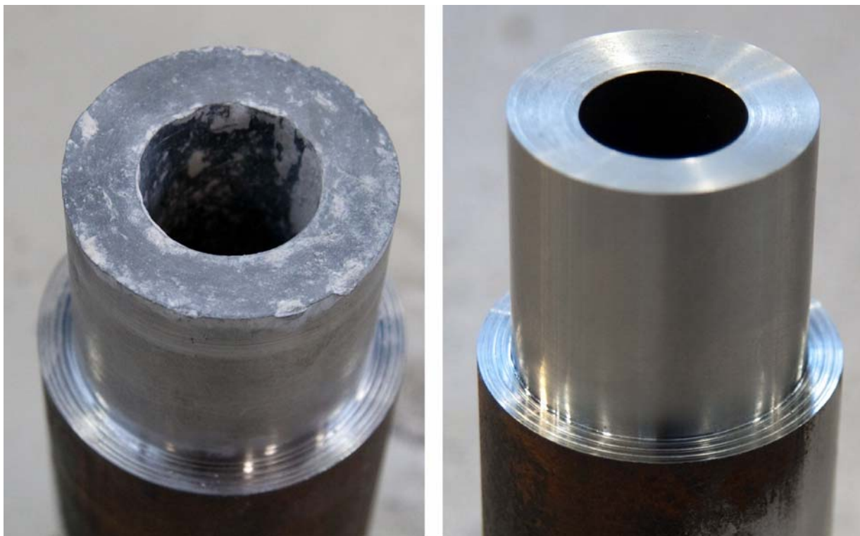
Figur 7-7: Før og etter bilde av spissen med konkav endeflate og forboring, slagserie 3.
