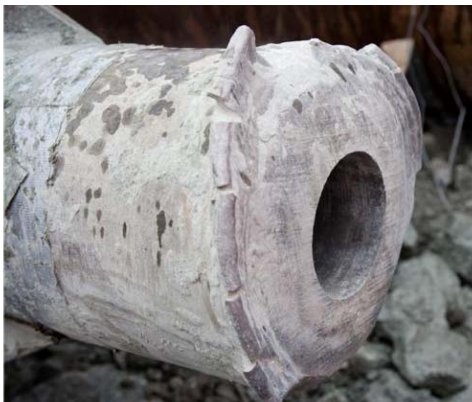
Underkant av spissenne etter at spissen ble rammet.
