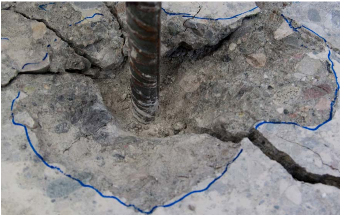
Figur 7-10: Krateret til den rette spissen med forboring, slagserie 4.
