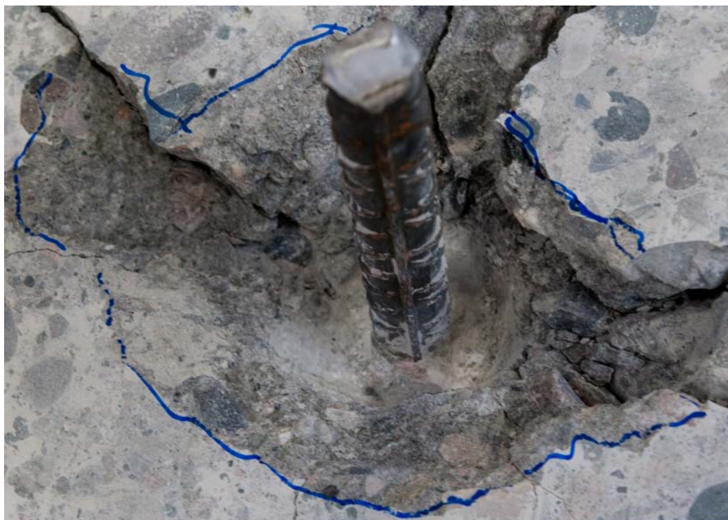
Figur 7-8: Krateret til spissen med konkav endeflate med forboring, slagserie 3.
