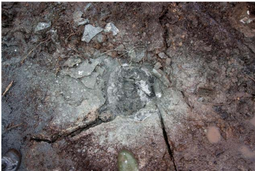
Figur 5-11: Bilder av berget i forskjellige stadier før og etter spiss nr. 3 ramming.
