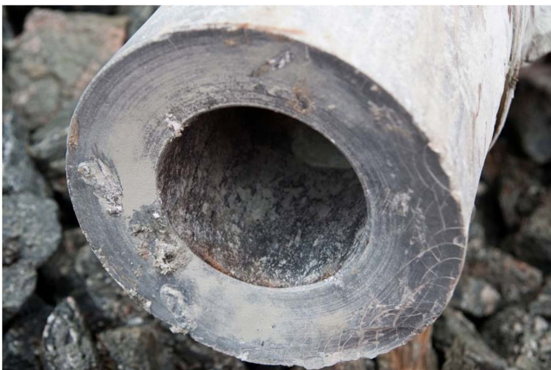
Underkant av spisseømne etter at spissen ble rammet.
