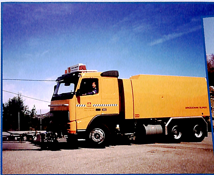
Ein stolt Harry Sæther viser fram den nye feiebilen til Kristiansund produksjonsområde. Bilen er av typen Volvo FH 12, og har feieaggregat Broadway super med høgtrykkspylebom. Feieaggregatet er hurtigkopla, slik at feiebilen kan gjerast om til ordinar lastebil med tippkasse på omlag ein time.
