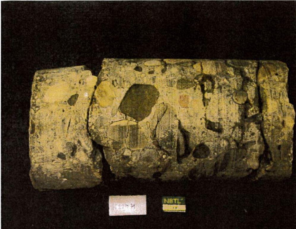
Figur 5.11: Fotografi borekjerne aks 19S, massiv
