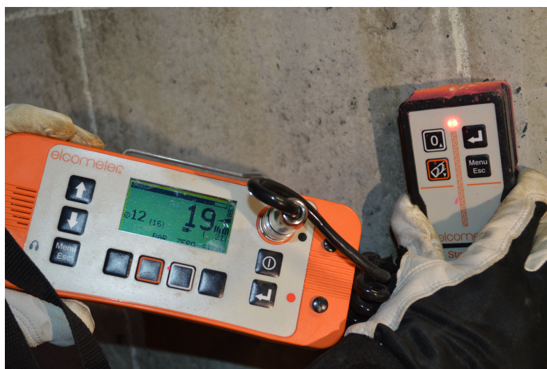
Figur 6.7: Målt overdekning med covermeter
