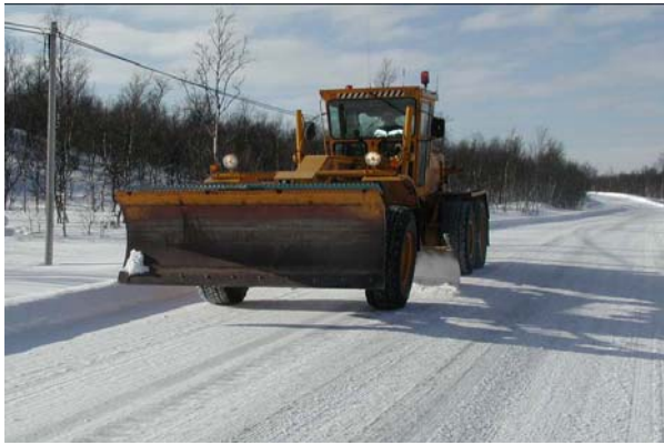
Figur 12.7 Veghøvel med underskjær i aksjon, til høyre jevnt snø-/isdekke etter høvling
