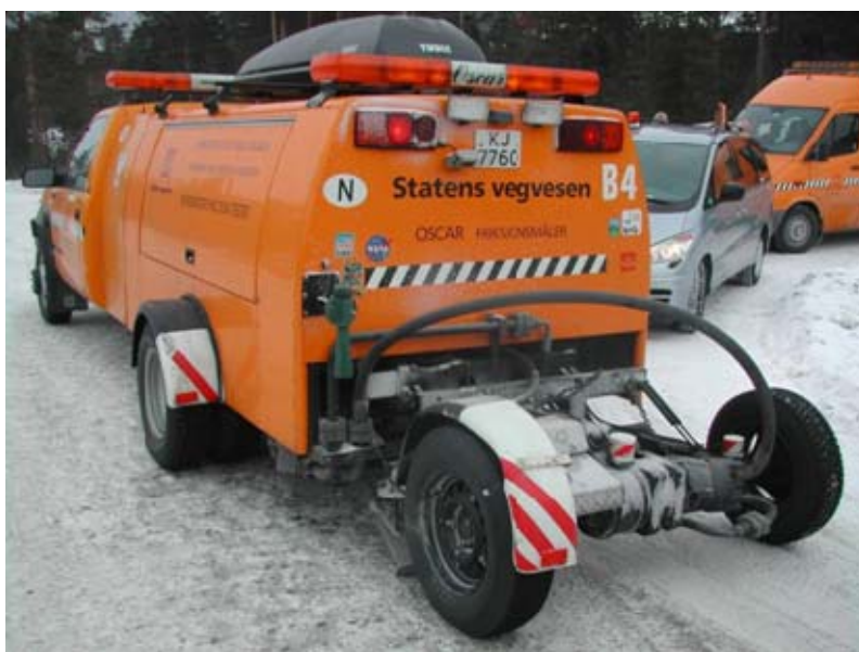
Figur 5.33 Friksjonsmåleren OSCAR er referansemåleren for friksjon i Norge
