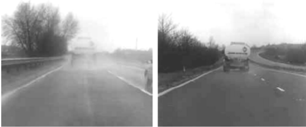
Figur 7.3 Våt vegbane kan gi svært dårlige siktforhold (TRB 09-1913, Rungruangvirojn and Kanitpong)
