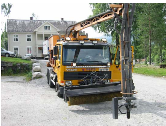
Figur 8.20 Lappekanon for reparasjon av hull (Mesta). (Foto: Noralf Haugvaldstad)
