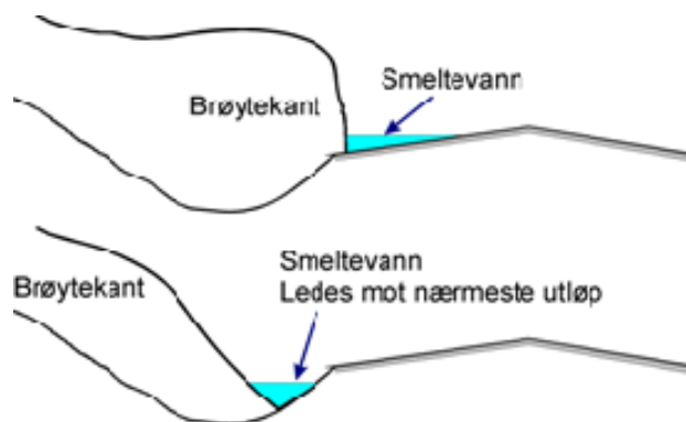
Figur 7.12 Viktig å fjerne brøytekantene for å skape avløp for smeltevannet (Illustrasjon: Geir Berntsen)
