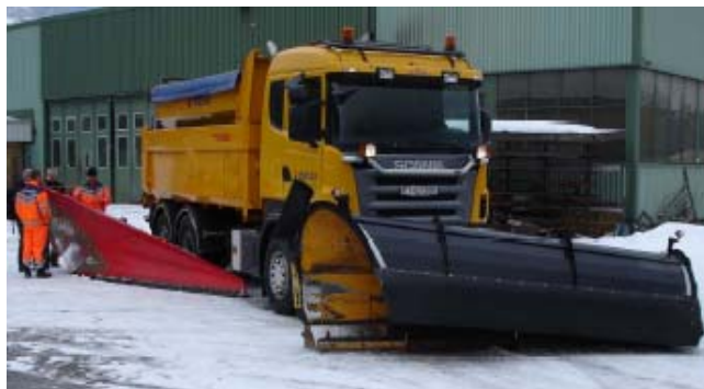
Figur 12.4 Brøyting med spissplog på høyfjellet (venstre) og brøytebil med diagonalplog og sideplog (høyre)
