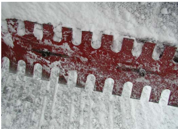
Figur 12.8 Isriverskjær, rødt Scana (venstre) og skjær av typen P300 (høyre)
