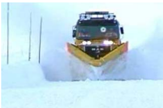
Figur 12.4 Brøyting med spissplog på høyfjellet (venstre) og brøytebil med diagonalplog og sideplog (høyre)
