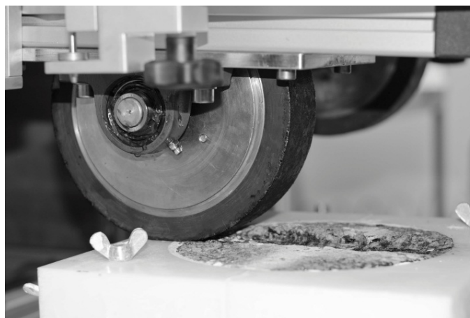
Figur 3.6 Wheel-track apparatur og prøve etter testing
