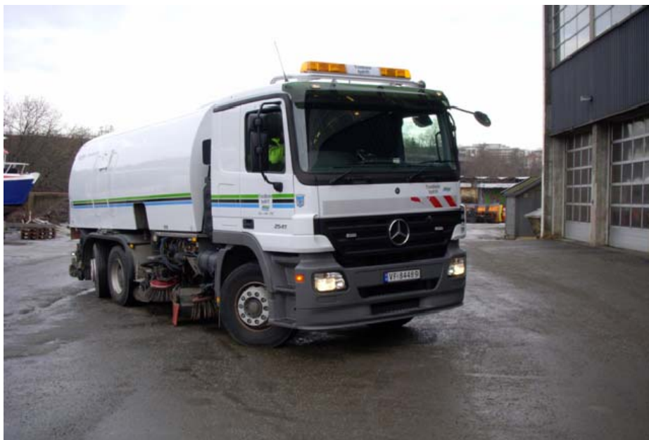
Figur 18.3 Stor feievogn som brukes til feiing av gater og veger i Trondheim
