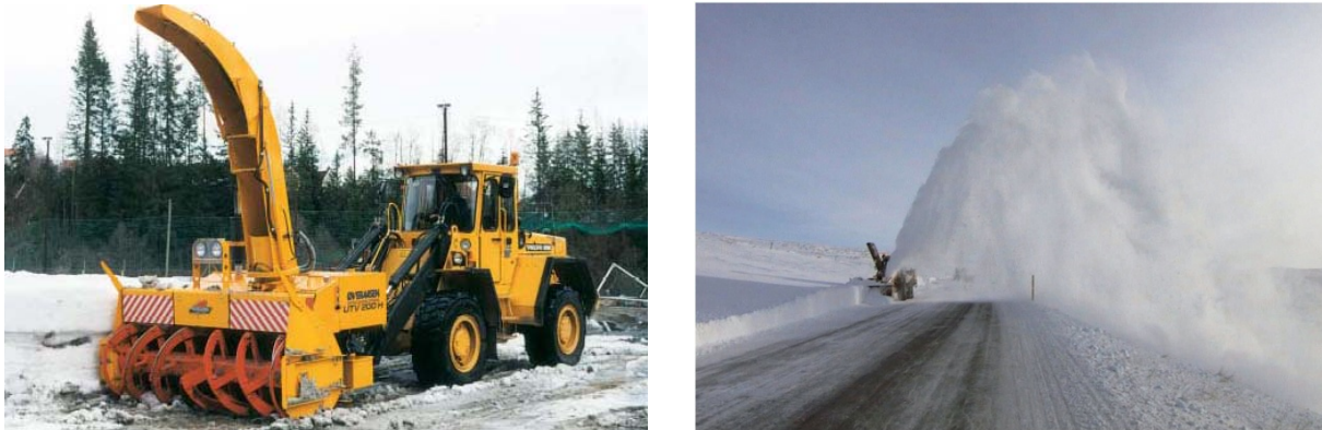
Figur 12.6 Hjullastermontert trommelfres (venstre). Bildet til høyre viser en snøfres som fjerner brøytekanter og kaster snøen tvers over vegbanen
