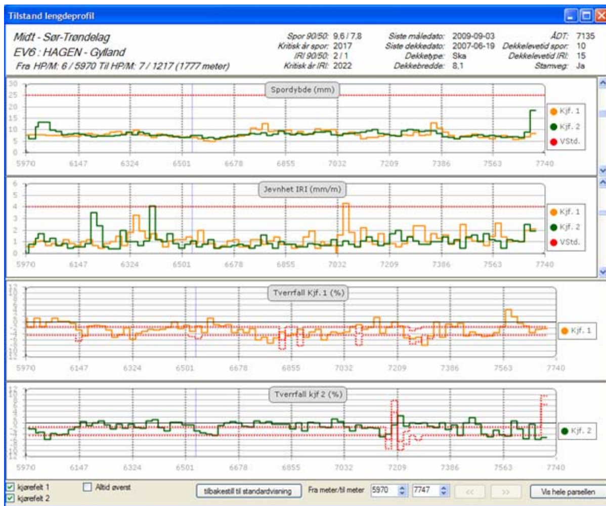
Figur 4.4 Lengdeprofilvisning av spor, jevnhet og tverrfall, 20 m intervaller (PMS)
