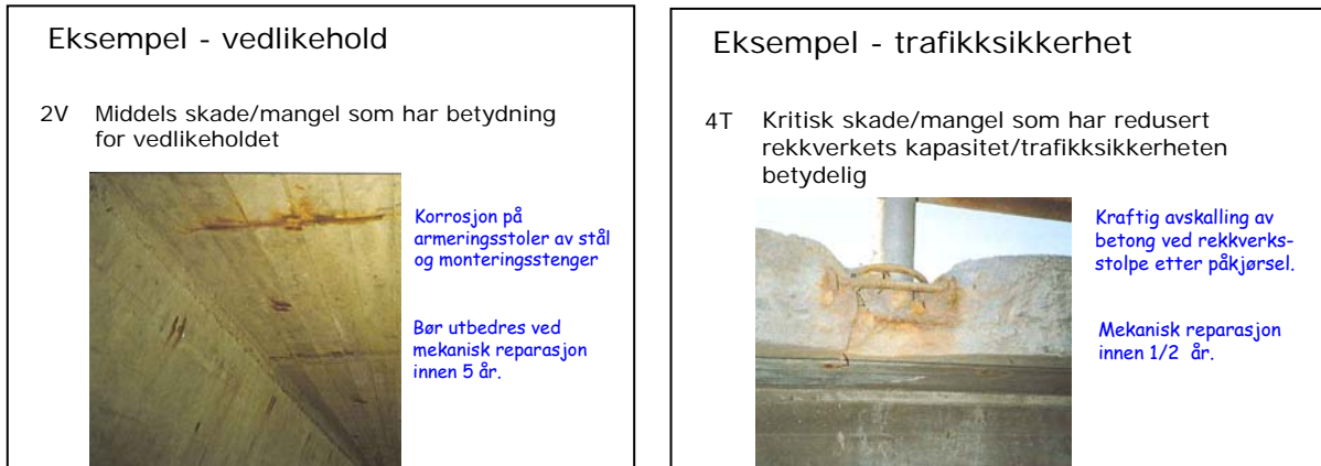
Figur 13.11 Eksempler på vurdering og klassifisering av skader på betong, med angivelse av skadegrad og skadekonsekvens (fra skadekatalogen i Håndbok 136)
