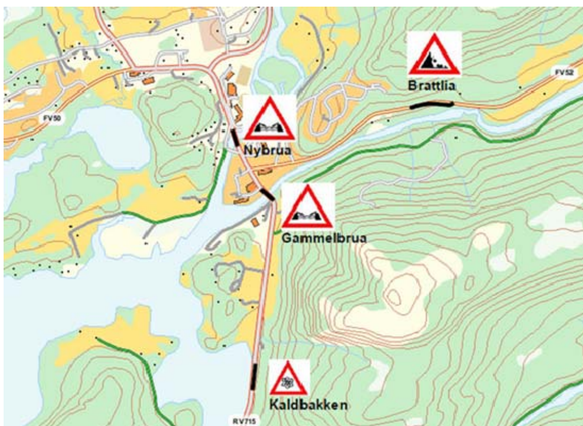
Figur 15.3 Kartutsnittet viser eksempler på identifiserte risikopunkter på vegnettet fra ROS-analysen. Symbolene antyder typer fare som enkelte punkt er utsatt for (kartutsnittet er kun en illustrasjon).
