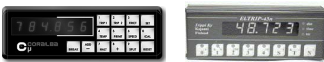
Figur 5.32 Displayet til henholdsvis Coralba-trip og Eltrip-45n retardasjonsmålere
