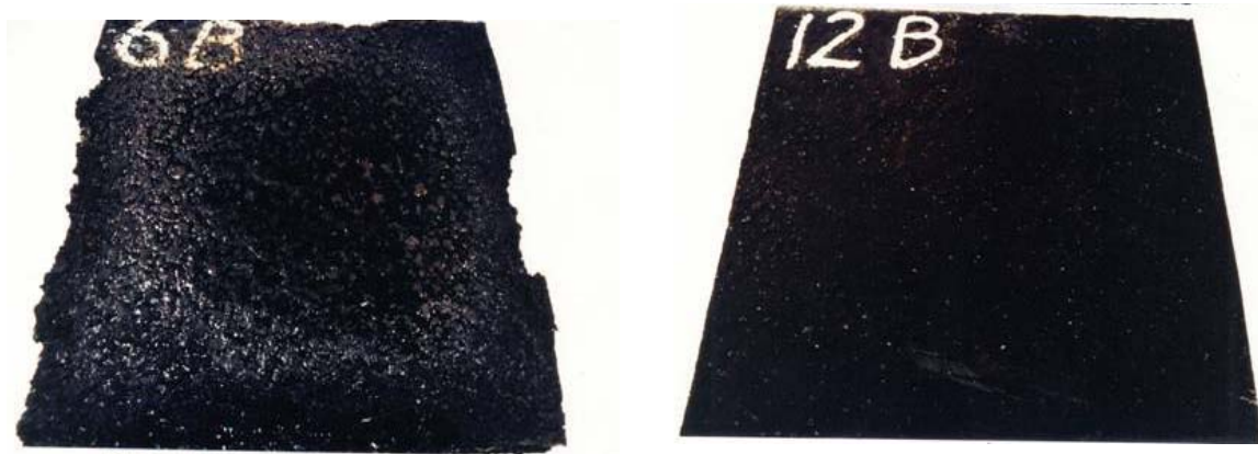
Figur 3.9 Prøver av Ab 11 (asfaltbetong) etter et halvt års simulert aldring i laboratorium, til venstre med ordinær bitumen 160/220, til høyre med bitumen 160/220 tilsatt 6 vekt-% polymer (Foto: Joralf Aurstad)
