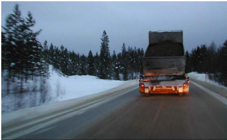
Figur 12.12 Strøing med tørr sand
