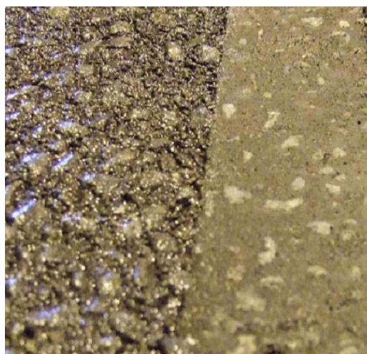
Figur 5.38 Høytrykkspyling av vegdekker. Behandlet asfalt til venstre, ubehandlet til høyre
