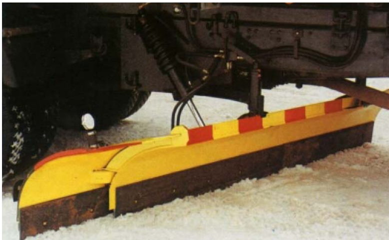
Figur 12.5 Underskjær montert på brøytebil (venstre) og Trelleplow gummiskjær (høyre)
