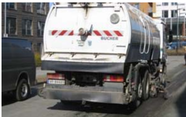
Figur 19.1 Feiebil med oppsug som brukes i bygater og tettsteder
