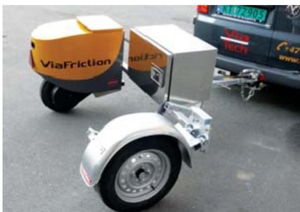
Figur 5.35 Ulike typer kontinuerlige målere (Fastslipp systemer)
