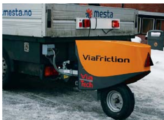
Figur 5.35 Ulike typer kontinuerlige målere (Fastslipp systemer)
