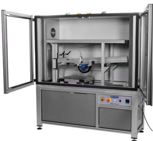
Figur 3.6 Wheel-track apparatur og prøve etter testing
