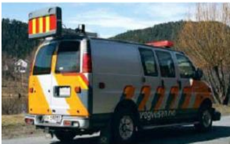
Figur 9.7 Tilstandsmålinger av spor og jevnhet utføres med ViaPPS
