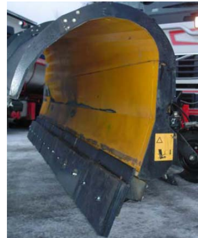
Figur 12.5 Underskjær montert på brøytebil (venstre) og Trelleplow gummiskjær (høyre)
