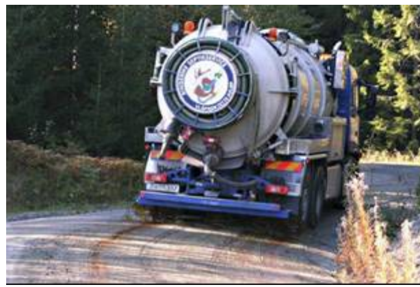
Figur 8.7 Støvbinding med lignin (Dustex). Utlegging med hhv gjødselspreder og tankbil
