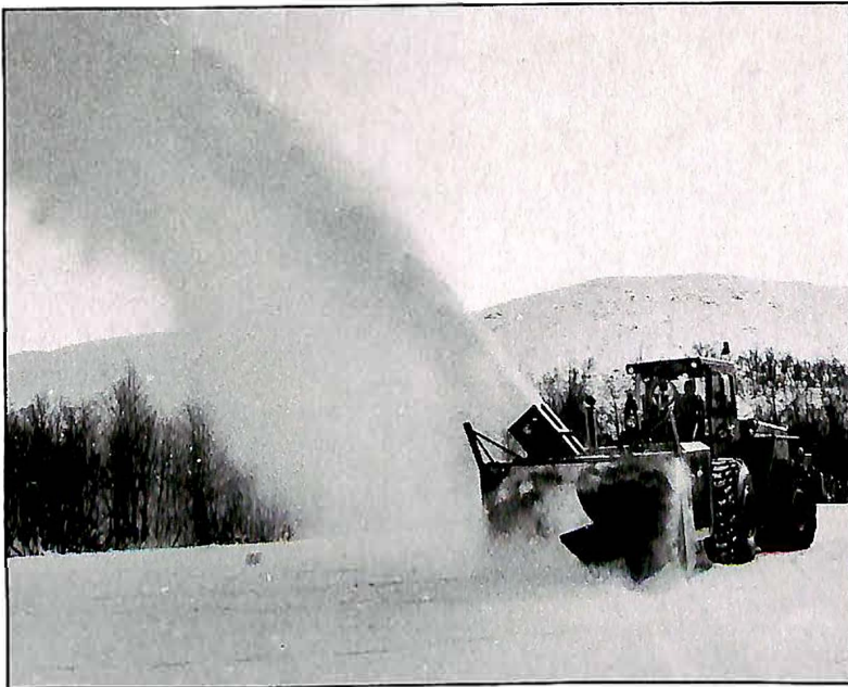
Det nye freseaggregatet på Hardangervidda kastar snøen 30 meter opp i lufta, men denne sesongen har det vore for fint ver til at ein verkeleg har fått utnytta materiellet til fulle.
