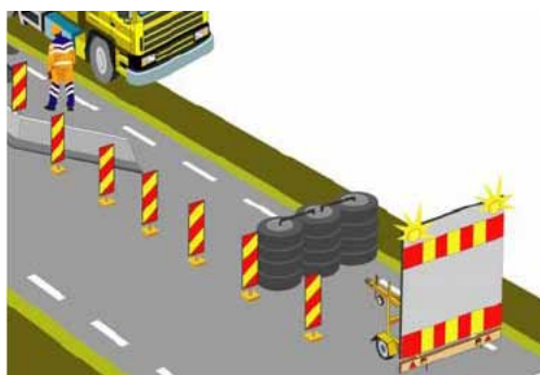
Figur 4.10 Tversgående sikring på kjørebanen, med varslingsutstyr.
