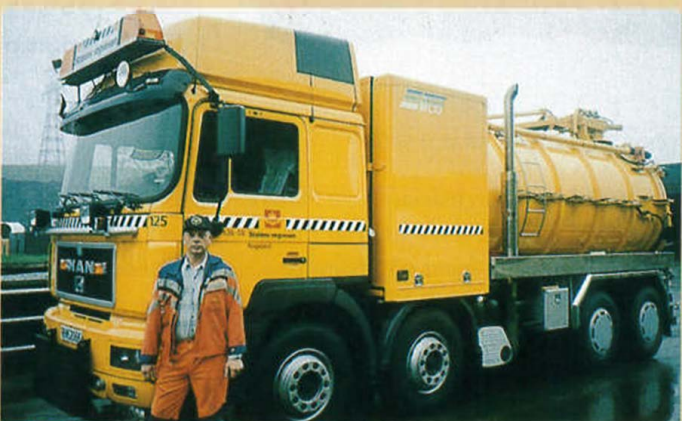
Ny slamsuger til produksjonsområde sør (POS), MAN 32463 med påbygget FICO sugeaggregat. Dette er en stor investering og Helge Reidar Wick har vært i Finland for å bli opplært i å bruke bilen og utstyret.
