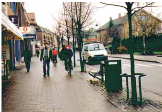
Tredelte brede fortau med møbleringsfelt "sykkelstripe" og gangareal
