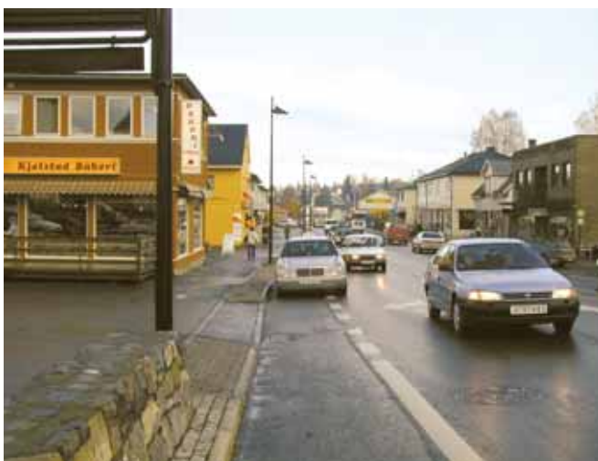
Parkering i sykkelfeltet. Fortauet avbrytes ved parkeringsplassen foran bakeriet
