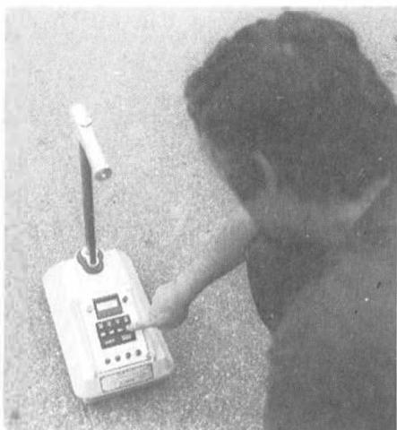
Isotopmåler, som Lab. bruker til å måle komprimeringen i vegdekket
