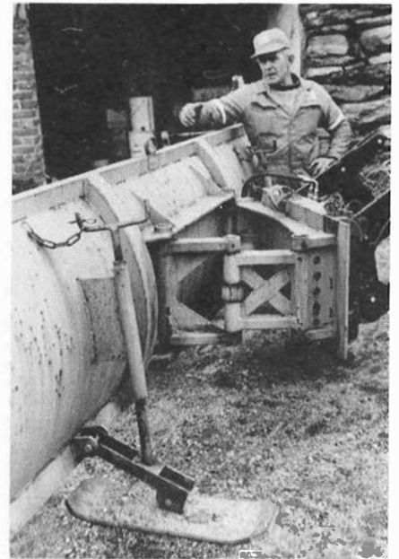
Sigurd Vågane forklarar systemet med den hydrauliske svinganretninga han har konstruert på skrapeploegen. Dette gjer redskapen meir avvendelege enn ved ei fast stilling.
