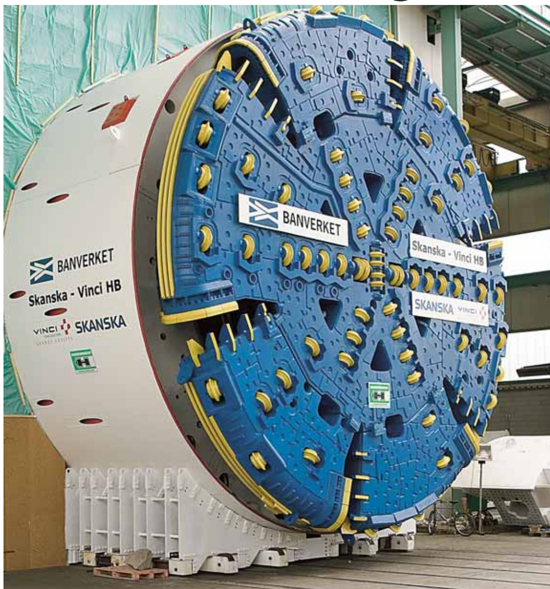
TBM: En fullprofilboremaskin som dette brukes nå på flere storprosjekt i Sverige og mange steder ute i Europa på vegtunnelbygging. (Foto: Herrenknecht)
