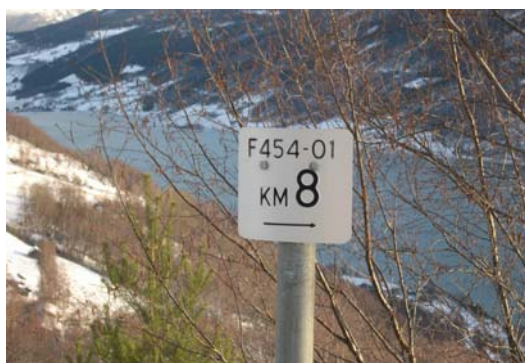
Figur 25: Slik ser dagens referansestolper ut. Skiltet beskriver fylkesveg nr 454, hovedparsell 1, meterverdi 8000. Pilen viser vegens metreringsretning. Foto: Magne Hov.
