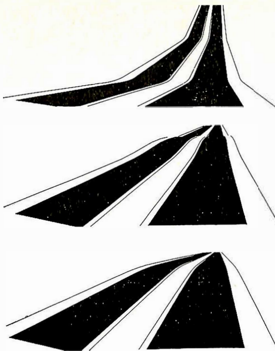
Fig. 16. Korte strekninger med jevn stigning mellom to vertikalkurver i samme retning bør unngås, så vegen ikke får preg av en brukket ryggrad. [5].
