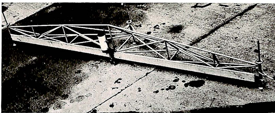
Fig. 7. Statens väginstitutets grafiska tvärprofilograf.
