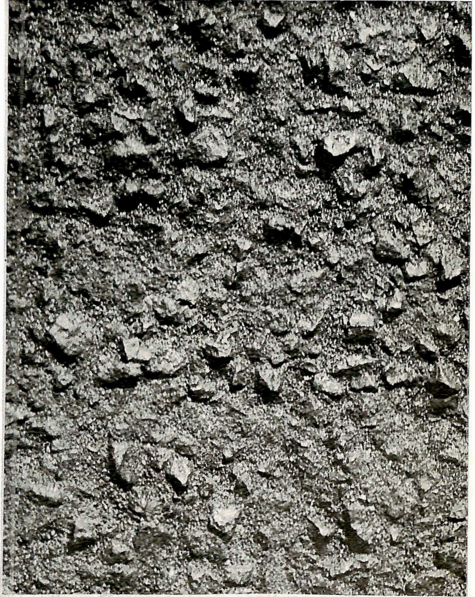
Fig. 8. 5-8 mm F.v/60-40-20 km/t:0,93-1,05-1,16 + asf.grovsand Bremselengde i m.: 13 - 5,5
