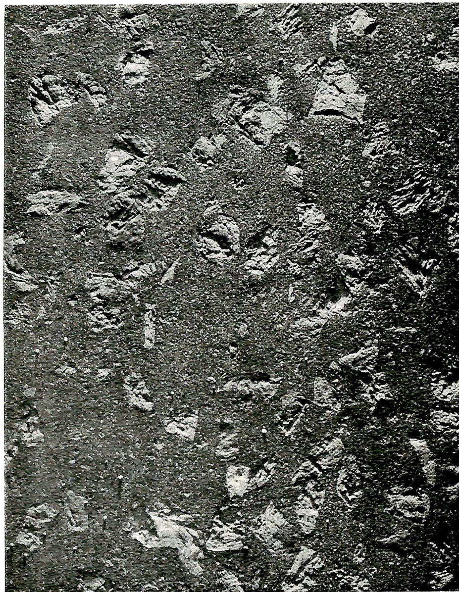
Fig.1. F.ved 60-40-20 km/t: 0,25-0,46-0,69 TOPEKA Bremselengde i m. : 34 - 10
