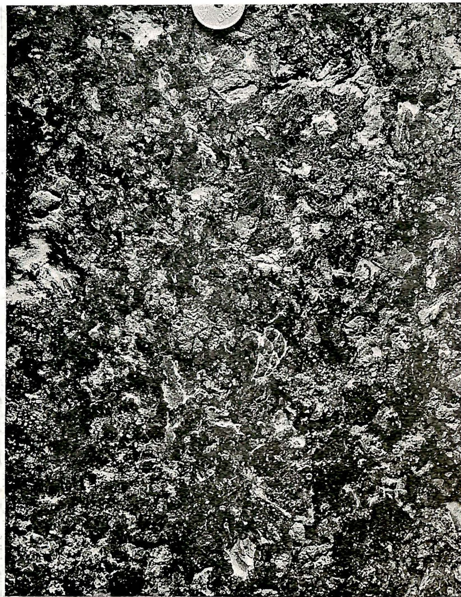
Fig.2. Mislykket F.v/60-40-20 km/t: 0,3-0,46-0,69 overfl.behandl. Bremselengde i m : 30 - 10
