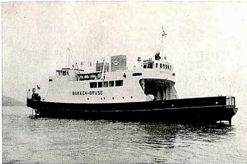
Fig. 3. «Bukken Bruse» er bygd i 1961 og har plass for 29 personbiler og 300 passasjerer. Den er satt inn i ferjesambandet Steinest—Knarvik.
