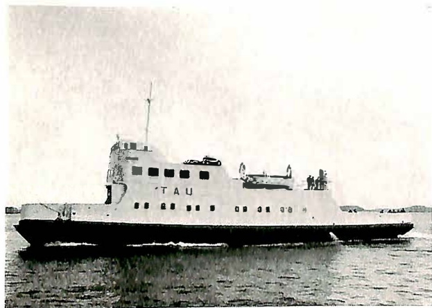
Fig. 1. Det Stavangerske Dampskibsselskabs nye ferje «Tau» som tar 475 passasjerer og 30 personbiler. Ferjen ble satt inn i sambandet Stavanger-Tau i mars 1961.
