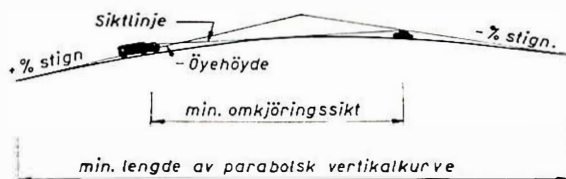
Fig. 14. Omkjøringssikt. Lengde av parabolisk vertikalkurve.
