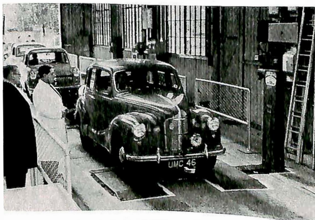
Fig. 5. Forhjulenes spissing kontrolleres på et «slipmeter».
