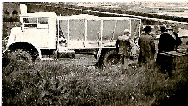
Fig. 23. Banffshire. Vogn for utkjøring og spredning av kalk.
